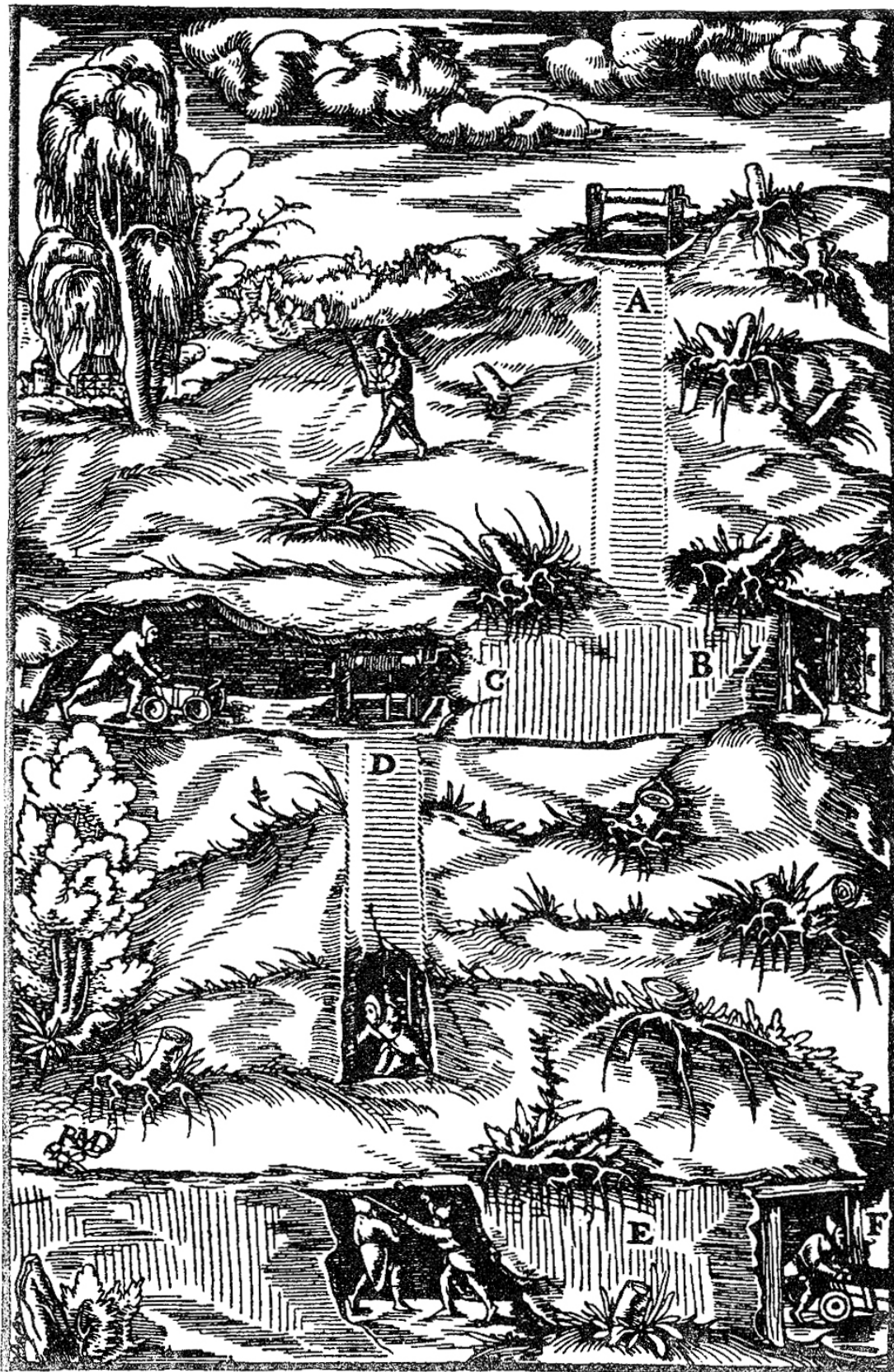
Шахтний стовбур А. Поздовжня виробка ВС. Сліпий стовбур (гезенк) D. Штольня Е. Устя (гирло) штольні F.
