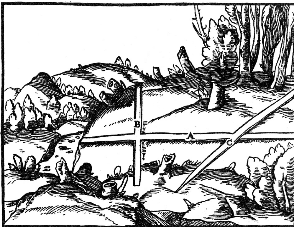
Головна жила А. Поперечна жила В. Жила С, що перетинає головну жилу навскіс.
