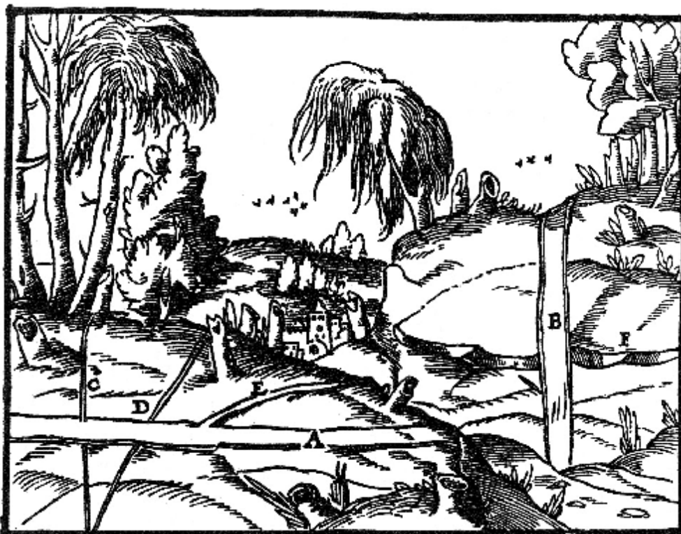
Жили А і В. Поперечний прожилок С. Прошарок D, що перетинає жилу навскіс. Приєднаний прожилок Е. Пластовий прожилок F.
