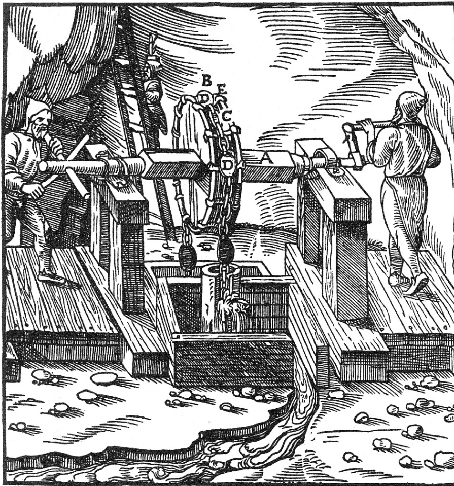
Вал А. Ланцюговий барабан В. Підймальний ланцюг С. Кулі D. Скоби Е.
