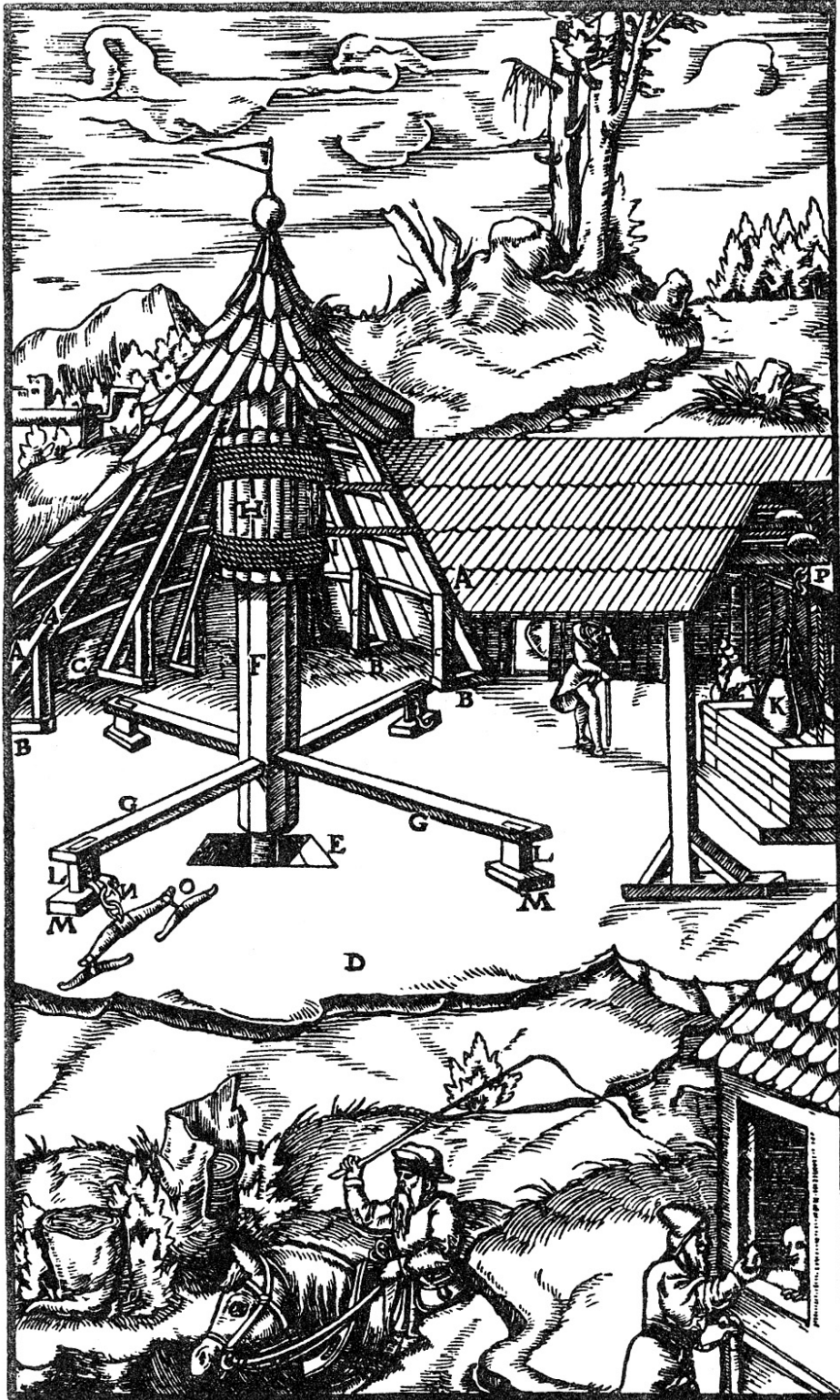
Балки А. Нижні горизонтальні бруси В. Підпорка С. Майданчик D. Дерев'яний брус під'ятника Е. Вал F. Поперечні подвійні бруси (коромисла) G. Барабан H. Канат I. Підіймальна посудина K. Бруси, що прикріплені до коромисла, L. Коротка дошка M. Ланцюг N. Дишло O. Гак P.
