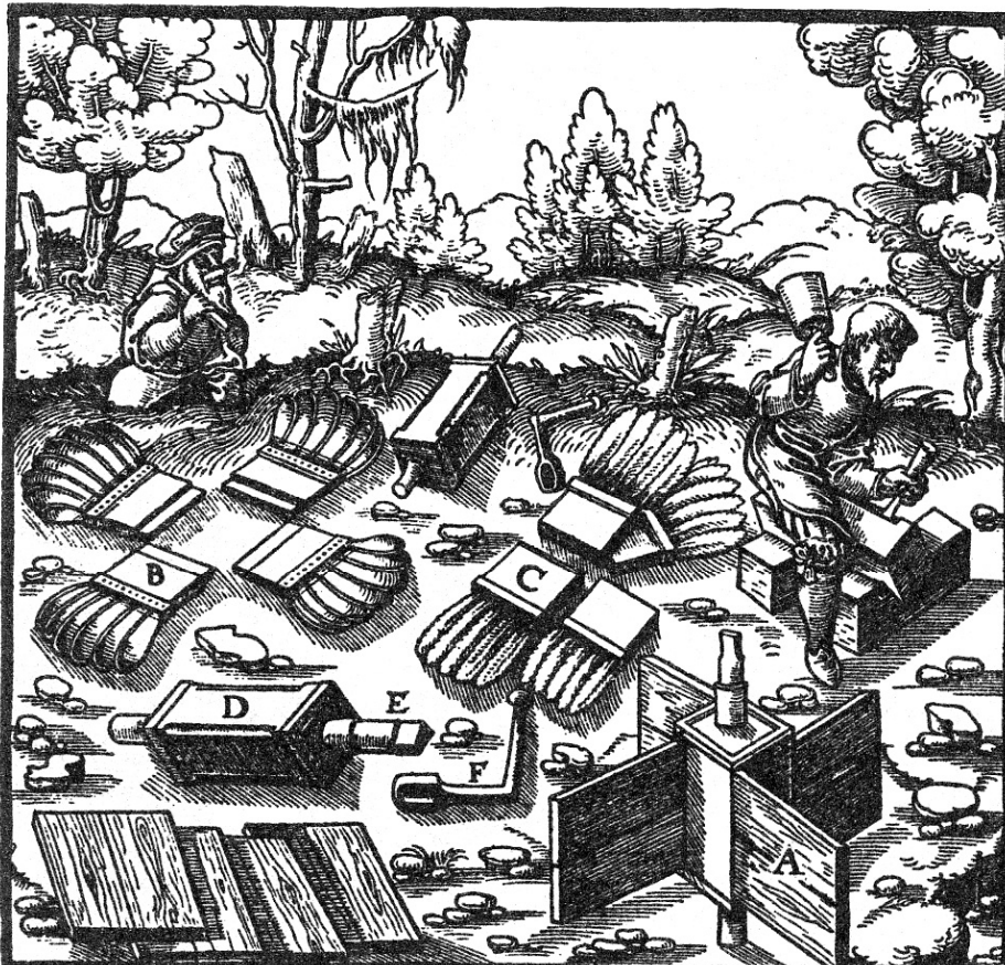
Крила першого роду А. Крила другого роду В. Крила третього роду С. Чотирикутна частина вала D. Кругла частина вала Е. Рукоятка F.
