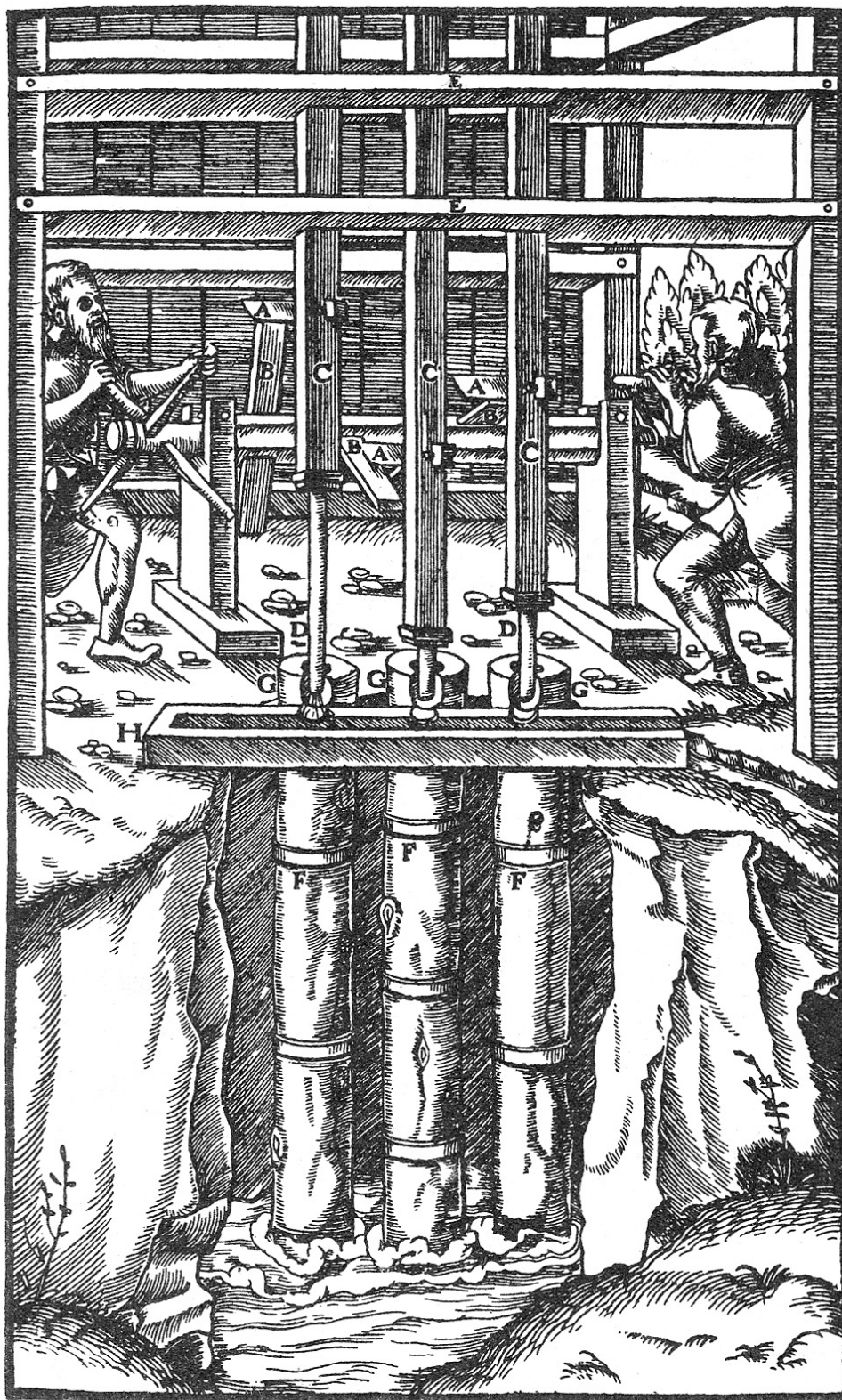
Підіймальний кулак поршневого штока А. Пальці вала В. Верхня чотирикутна частина поршневого штока С. Нижня кругла частина поршневого штока D. Поперечна балка Е. Труби F. Стічний отвір G. Жолоб H.
