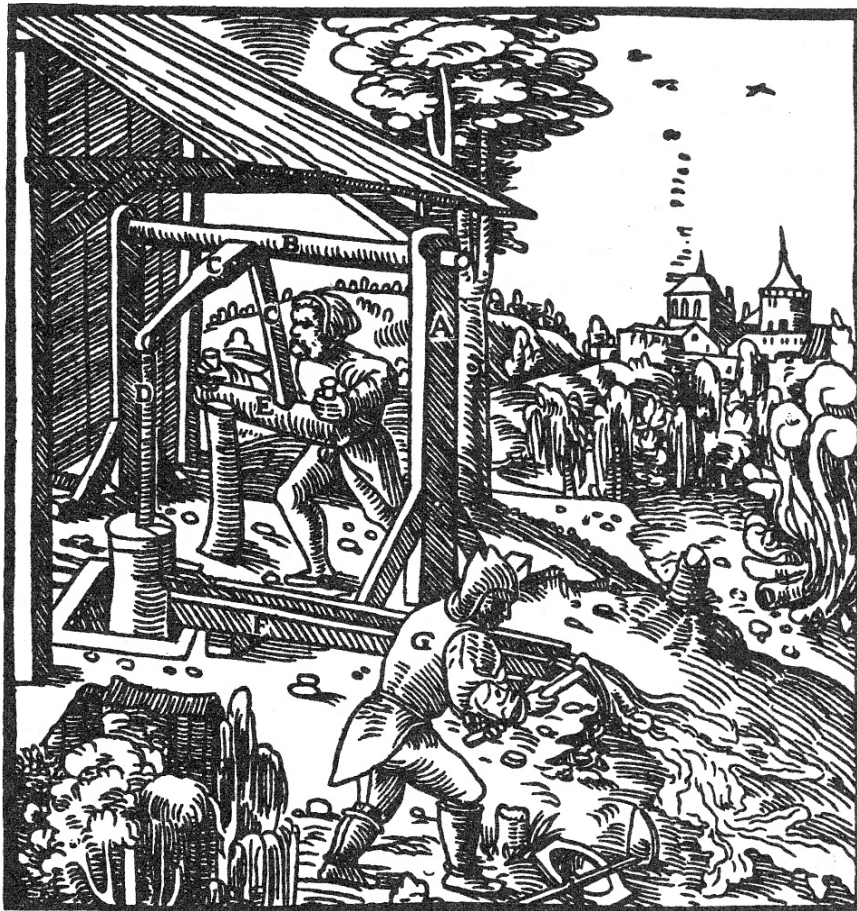
Стояки А. Вал В. Поршневий шток D. Рукоятка E. Жолоб F. Робочий відводить воду так, щоб вона не потрапляла у гірничі виробки G.
