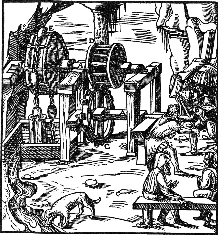
Вали А. Хрестовина В. Зубчасте колесо С. Цівкова шестерня D. Ланцюговий барабан зі скобами Е.
