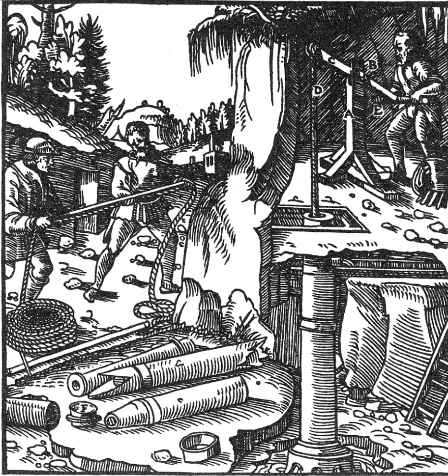
Стояк А. Вал В. Обертове коромисло С. Поршневий шток D. Рукоятка Е. З'єднувальне кільце F.
