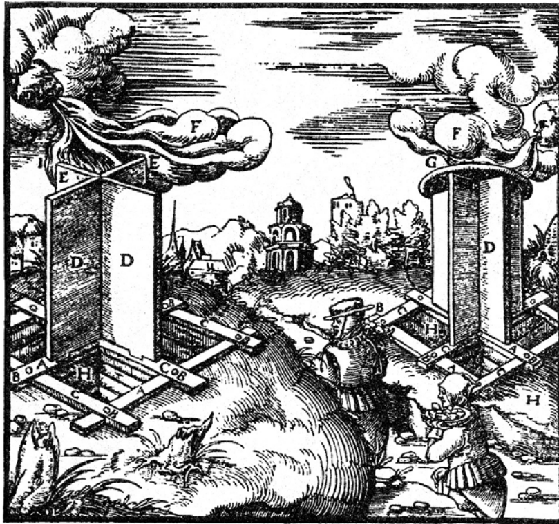
Горизонтальні балки А. Загострені кілки В. Поперечні балки С. Дошки (щити) D. Відкриті порожнини E. Вітри F. Дах G.
