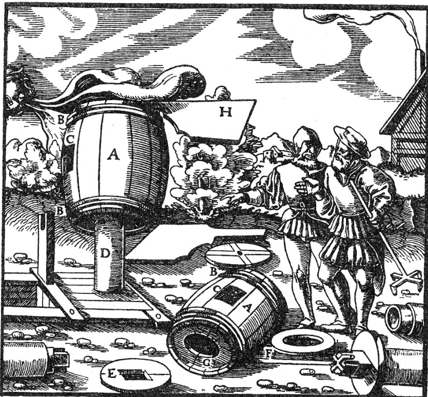
Дерев'яна бочка А. Обручі В. Повітряний отвір С. Труба D. Диск Е. Вісь F. Отвір у дні бочки G. Крило Н.
