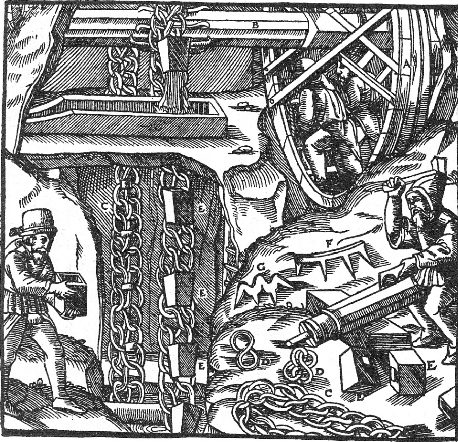
Ступінчасте колесо (топчак) А. Вал В. Подвійний ланцюг С. Ланки подвійного ланцюга D. Ковші Е. Проста скоба F. Тричі вигнута скоба G.
