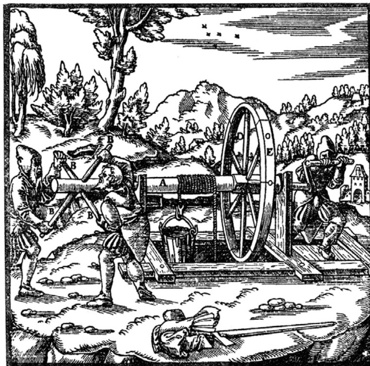
Вал А. Хрестовина В. Звичайна рукоятка С. Спиці колеса D. Обід Е.
