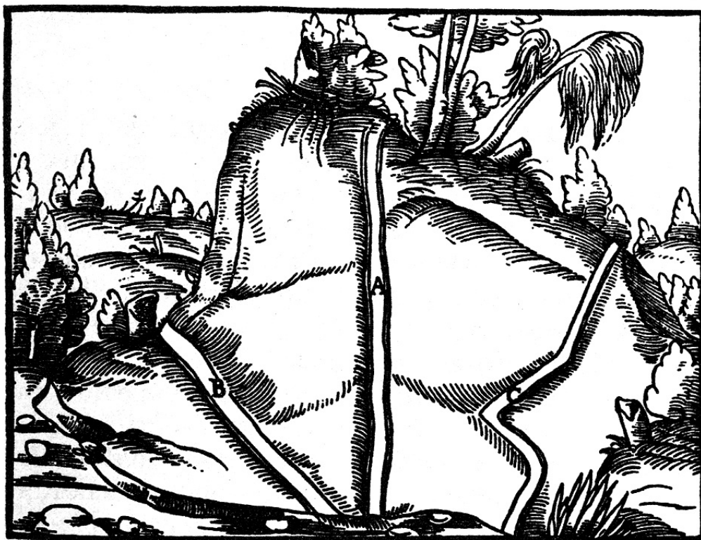
Крутоспадна пряма жила А. Похила жила В. Вигнута жила С.
