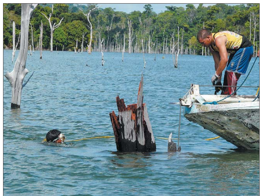
Der Taucher sichert den Stamm mit Kette und Drahtseil, bevor er ihn absägt
