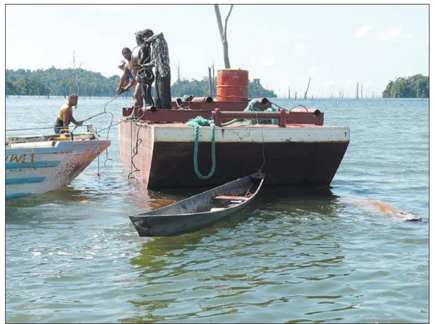
An solchen Pontons werden die geborgenen Stämme befestigt und dann mit einem Schleppboot zum Sägewerk gebracht
