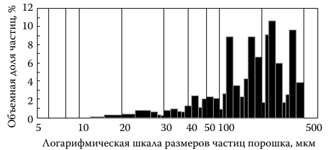
Рис. 5. Распределение размеров частиц насыпки порошка по объему
