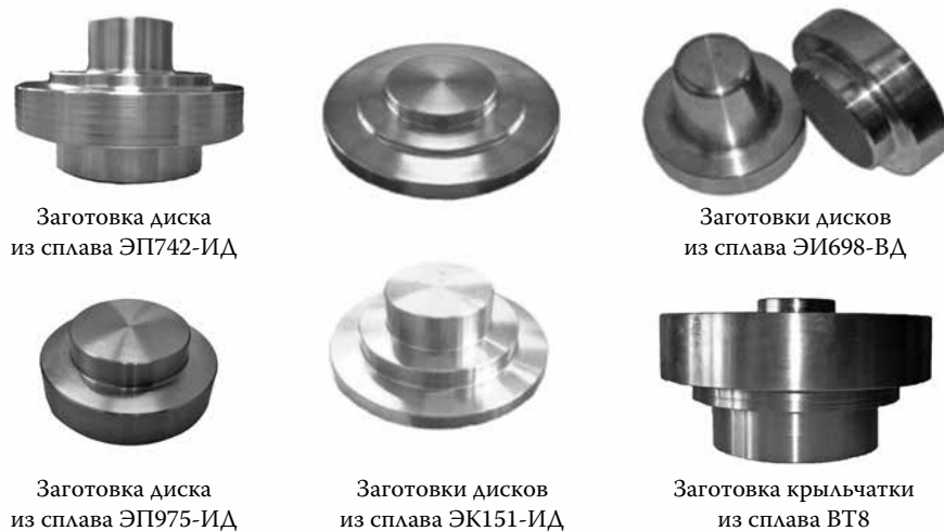
Рис. 2. Заготовки дисков турбины из жаропрочных никелевых сплавов и крыльчатки компрессора из жаропрочного титанового сплава VT8
