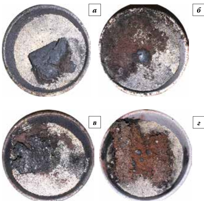
Рис. 6. Внешний вид продуктов восстановления образцов рудоугольных брэкс и шлака в тигле: а – № 2; б – № 3; в – № 4; г – № 1
