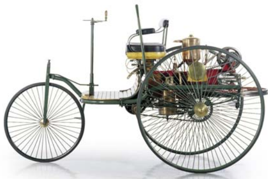
Der Benz-Patent-Motorwagen Nr. 1 war das erste von Carl Benz erbaute Automobil mit Verbrennungsmotor. Das Patent für dieses Dreiradfahrzeug wurde 1886 erteilt. Heute stellt sich dagegen die Frage, ob das Patentsystem die Innovation in entwickelten Industrien hemmt. Bilder: Archiv
