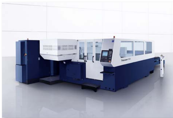
Automatisierte Fertigungsabläufe an einer Laser-Maschine TruMatic 3030 dank des Gebhardt CNC-Maschinen Interface.
