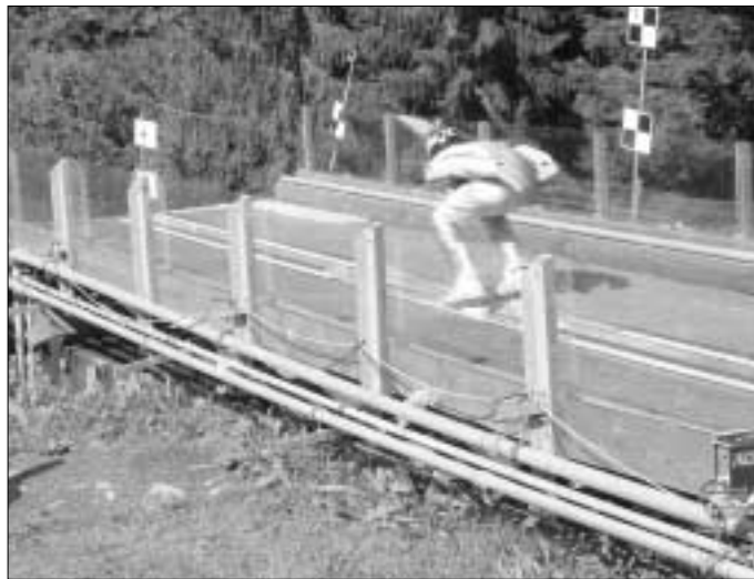
Mit Messdruckplatten ausgestattet wurde die Anlaufspur der Adlerschanze in Hinterzarten. Damit können die beim Absprung auftretenden Kräfte exakt erfasst werden. (Fotos: Wiedmann)
