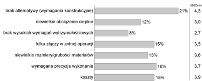
Rys. 14. Powód wyboru lutowania jako technologii spajania Fig. 14. Selection reason of soldering/brazing as a joining technology
