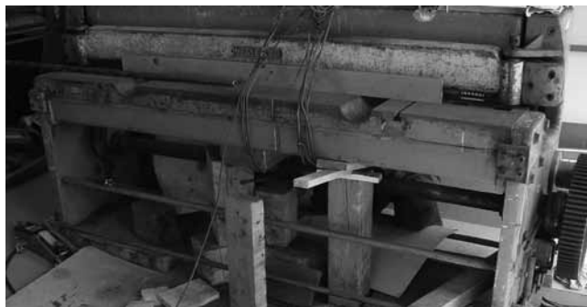
Rys. 3. Przygotowanie do spawania belki dolnej zamocowanej na gilotynie
