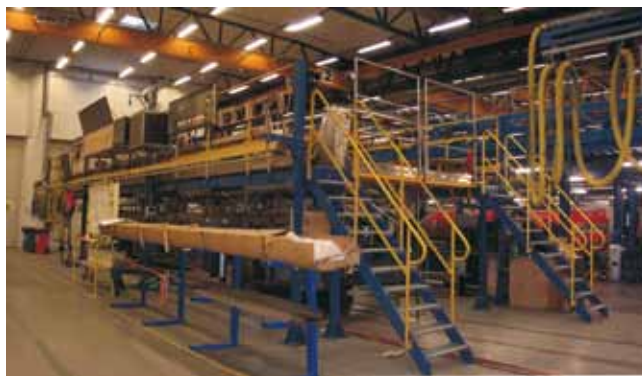
Rys. 5. Dok do montażu pudeł autobusu. Podesty górne do montażu części dachowej. Regały z elementami pudła oraz zawieszono spawarki
