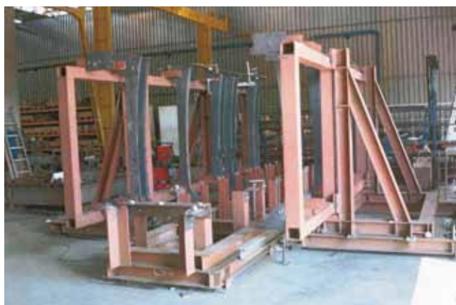
Rys. 6. Konduktor do montażu prototypów i do serii próbnej pudeł samochodów dostawczych typu furgon. Ramy montażowe na odsuwanych suportach
