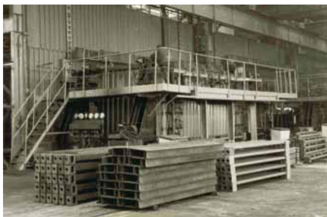
Rys. 3. Przyrząd główny do montażu kontenera 20-stopowego, zmagazynowane słupki oraz belki z narożami
