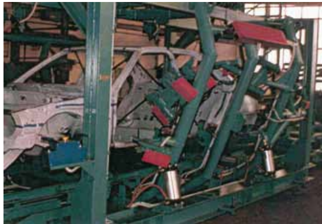
Rys. 10. Konдукtor do montażu i zgrzewania nadwozia samochodu Peugeot 405. Wewnątrz „Master model”, a na zewnątrz odchylona rama montażowa ściany bocznej Fig. 10. Car body of Peugeot 405 instrument for assembling and welding. Inside the „Master Model” and the outside the side wall frame assembly of side wall inclined
