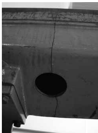
Rys. 2. Pęknięcie na dolnej belce gilotyny
