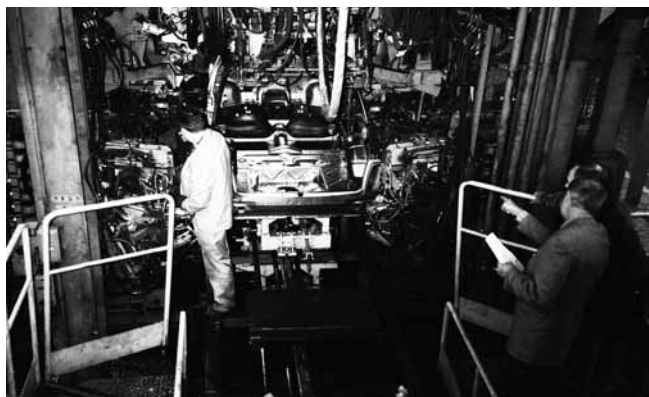
Rys. 13. Linia konдукtorowa FSO Polonez w trakcie modernizacji pod pudło nadwozia Polonez Caro
