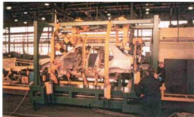
Rys. 11. Konдукtor do montażu i zgrzewania pudła karoserii samochodu Peugeot 309 w trakcie montażu i dopasowania baz do „Master model” Fig. 11. Car body of the Peugeot 309 instrument during assembly and matching bases for the „Master Model”
