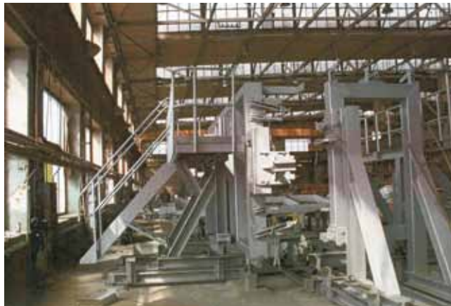
Rys. 4. Konduktor z rozsuwanymi suportami, w których osadzone są wędrujące ramy montażowe. Odsunięte suporty ułatwiają osadzenie w nich ram montażowych ze ścianami pudeł oraz wyjęcie całego pudła po zespawaniu
