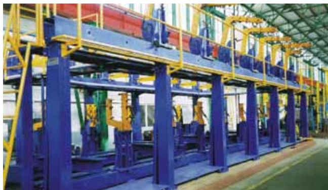
Rys. 2. Przyrząd główny do montażu trzech członów pudła tramwaju N-116. W płaszczyźnie dolnej i górnej widoczne przesuwane ręcznie kolumny ustalające i mocujące słupki szkieletów ścian bocznych
