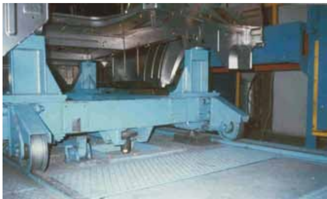
Rys. 8. Wózek technologiczny i zarazem przyrząd do bazowania podłogi. Ustalanie i mocowanie wózka na stanowisku montażowym w konдукtorze Fig. 8. Block carriage and also an instrument for the floor basing. The block carriage at the assembly point in the instrument determining and fixing
