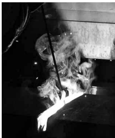
Rys. 7. Spawanie belki zamocowanej w urządzeniu w pozycji podolnej
