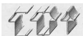
Rys. 13. Elementy ram i okien z cienkiej blachy przeznaczone do spawania [8] Fig. 13. Thin metal parts of window and window for welding [8]
