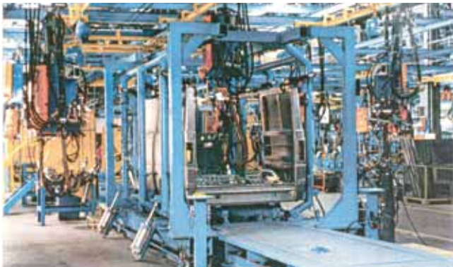
Rys. 7. Linia konдукtorowa czterostanowiskowa: Stan. 1. – załadunek podłogi na wózek technologiczny; Stan. 2. – montaż ścian i zgrzewanie; Stan. 3. – montaż dachu i zgrzewanie; Stan. 4. – zdjęcie pudła furgonu. Ramy montażowe ścian bocznych odchylane siłownikami pneumatycznymi
