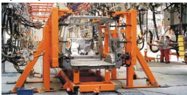
Rys. 9. Linia konдукtorowa do montażu i zgrzewania nadwozia samochodu VW-T4 dla serii 150 szt./dzień. Odsuwane supory z ramami montażowymi do ścian bocznych, transport skidowy w obiegu zamkniętym, powrót kanałem pod przyrządami. Skidy z nadwoziem bazowane na każdym stanowisku w linii Fig. 9. Instrument line for assembling and welding of VW T4 car body for a series of 150 pieces/day. The framework of mounting slides to the side walls, skidded transport in closed circuit a return channel under devices. Skid with the body on any position on the line are based
