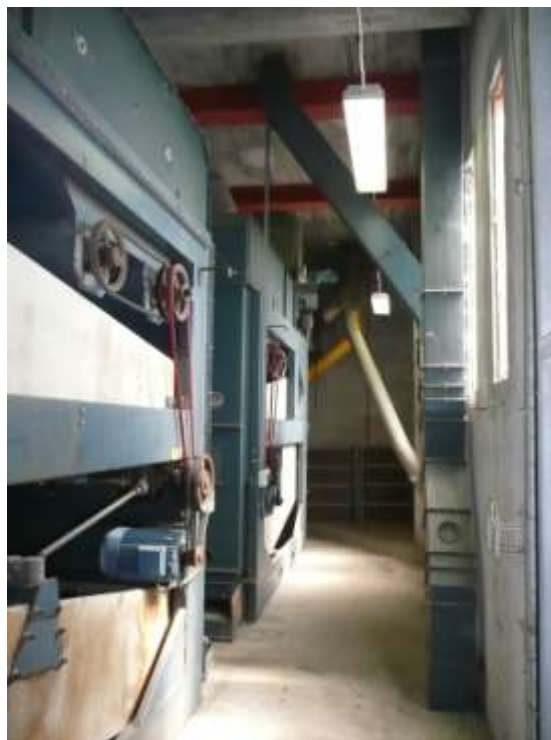
Foto Kulturen. Vid botten av silorna. Luckor i rundcellerna. Tvåvägsfördelare, rör, från stjärnceller leder spannmålet till transportören under golvet för utlastning. Höger: Rens från CIMBRIA i maskintornet på övre plan.
