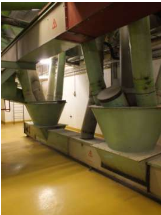
Foto Regionmuseet Kristianstad: Till höger detalj av rörsystem från torkarna in till olika silor. Till höger en whiteboard med recept över foderprodukter.
