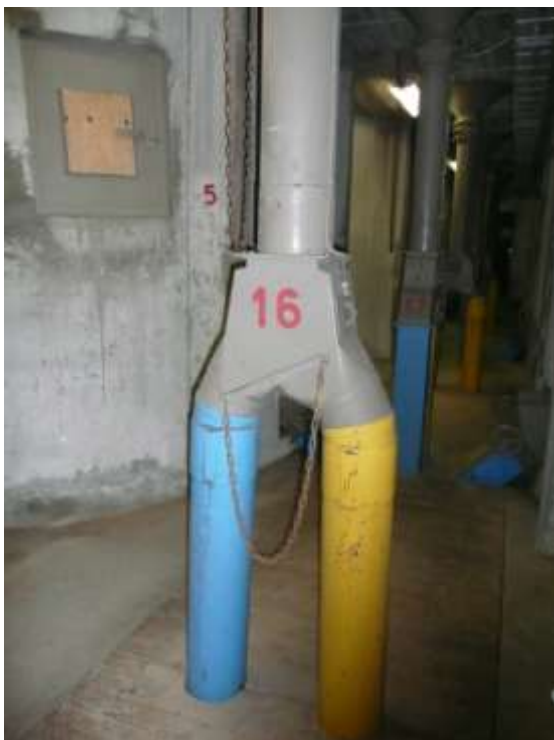
Foto Kulturen. Vid botten av silorna. Luckor i rundcellerna. Tvåvägsfördelare, rör, från stjärnceller leder spannmålet till transportören under golvet för utlastning. Höger: Rens från CIMBRIA i maskintornet på övre plan.
