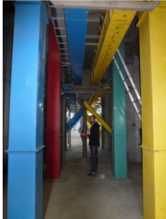
Foto Kulturen. Verkstad på första våningen under en silocell. Till vänster i bild går man in till pannrummet och till höger står maskintornet. Under brädorna i golvet går transportbandet för utlastning på järnväg. Höger: Systemet med elevatorer och transportband är markerat med färg för olika silor. Våningsplanen är höga och miljön är alltid välstäddad och ren.
