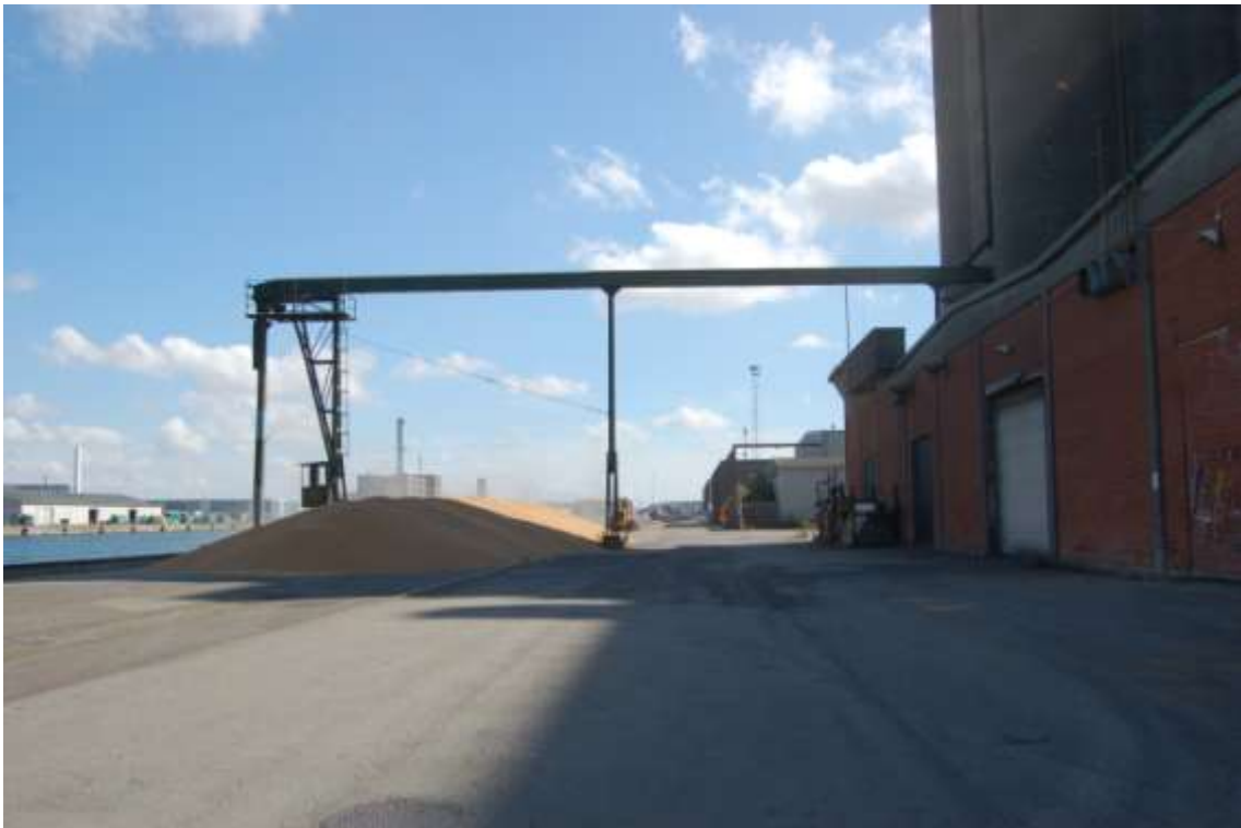
Foto Malmö Museer. Tillfälligt lager på marken och transportband för lastning från silo till båt.
