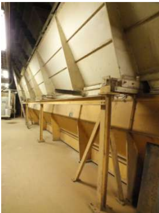
Foto Regionmuseet Kristianstad: Till vänster interiör från torkanläggning. Plåt skapar skiljeväggar för att inte blanda olika delar av produktionen. Till höger hissdörr.
