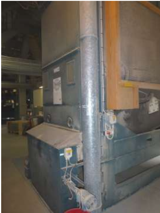
Foto Kulturen. Rens från CIMBRIA, innan torkning och lagring rensas spannmålen. I lanterninen finns transportbandet som fördelar spannmålen i silorna efter torkning.
