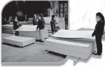
品質監控團隊進行隨機測試，確保膠合板產品品質。完成品質測試後，膠合板產品經過包裝便可交付予客戶。
