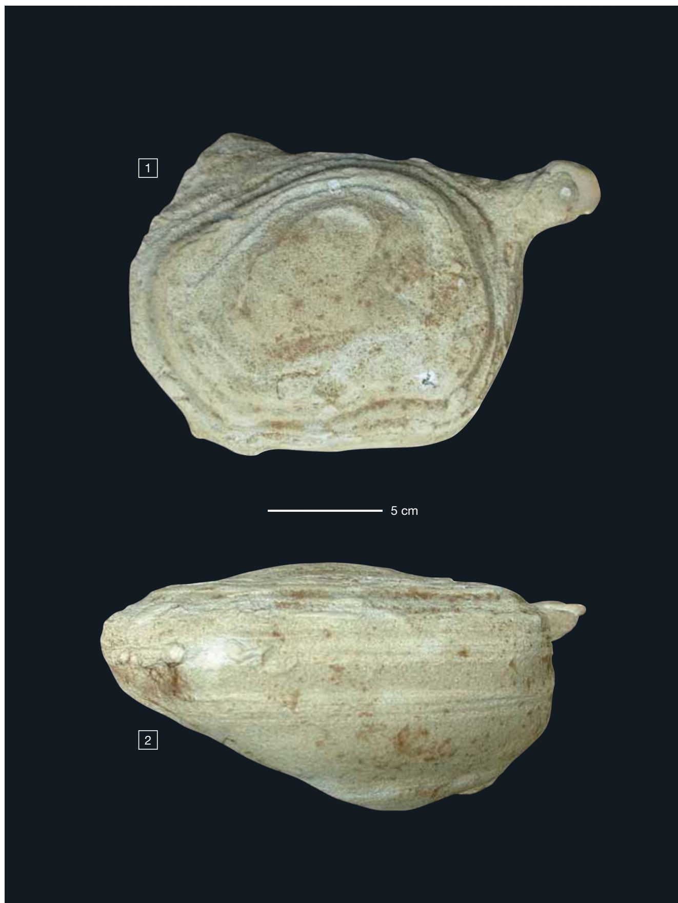
Planche 9 : ZAVENTEM – Zaventem Vliegveldtunnel - 88 E 773 : Bloc de grès-calcaire stratifié silicifié de type grès fistuleux . Echantillon traité et préservé. 1 : Face supérieure de l'échantillon. 2 : vue latérale de l'échantillon. Clichés Guy Van Den Eeckhaut. Août 2010.
