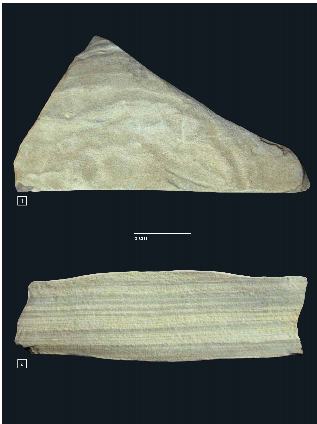
Planche 11 : ZAVENTEM – Zaventem Vliegveldtunnel - 88 E 773 : grès, de type dalle de grès plane , finement stratifié (alternances rapides de linéoles sableuses, silteuses et marneuses). Echantillon traité et préservé. 1 : vue de la face supérieure du bloc. 2 : section (brisure naturelle) de l'échantillon. Clichés Guy Van Den Eeckhaut. Août 2010.
