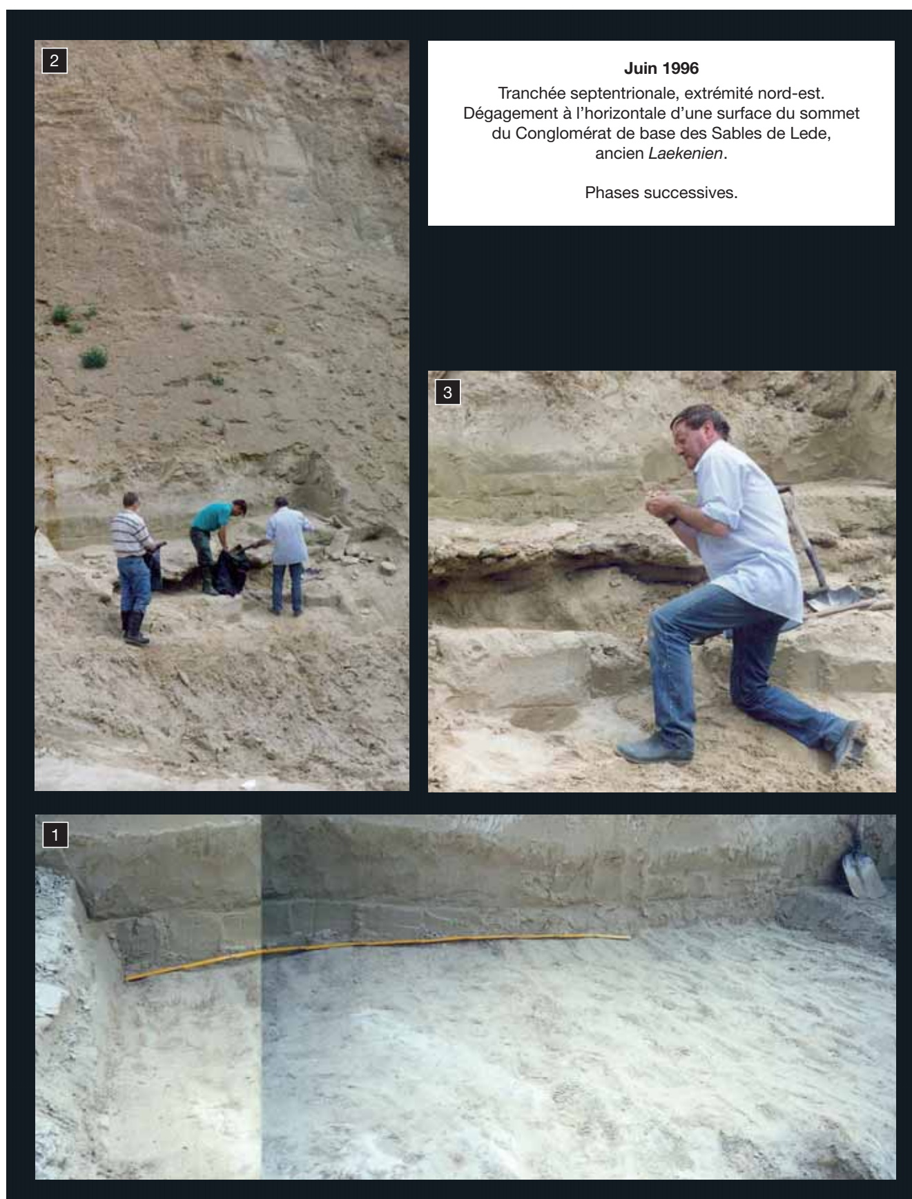
Planche 15 : ZAVENTEM – Zaventem Vliegveldtunnel - 88 E 773 : 1 : La pelleuse a enlevé la quasi totalité de la couverture de Sables de Lede sensu stricto. L'approche se fait à la pelle plate. 2 : après le lavage au jet d'eau à faible pression et nettoyage complet de la surface supérieure du conglomérat (cf. planche suivante), les prélèvements peuvent commencer en compagnie de H. Goossens et de F. Moorkens (SGB). 3 : J. Herman (SGB) devant la section du conglomérat. Juin 1996.
