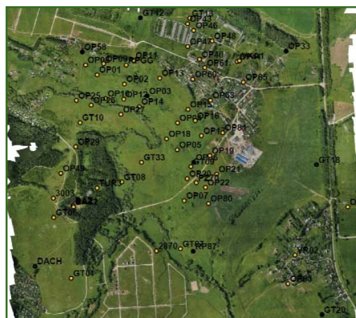
Рис. 9 Схема расположения опорных и контрольных точек для блока АФС БЛА GeoScan 101
