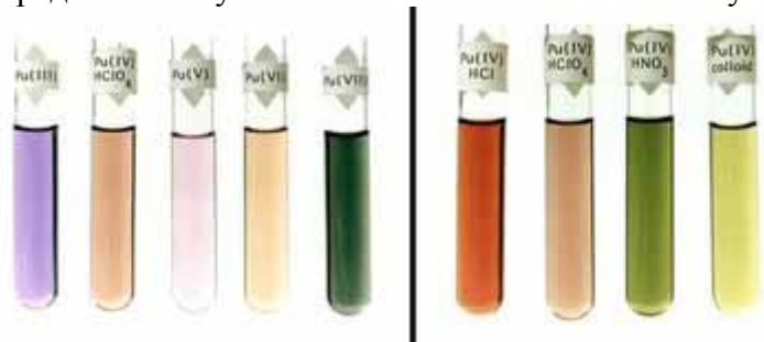
Рис. 20. Окрашивание водных растворов с плутонием в разных состояниях окисления (слева) и цвета растворов с плутонием только одной валентности (IV) но с различными анионами (справа).
