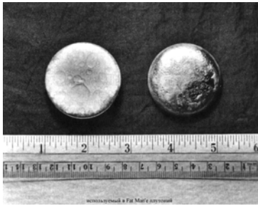
Рис. 50. Плутониевые изделия, изготовленные во время манхэттенского проекта на представленном на предыдущем снимке прессе. Две полусферы из плутониево-галлиевого сплава, покрытые снаружи никелем для защиты от коррозии. Из них было изготовлено ядро одного из первых американских атомных взрывных устройств. В современных мощных атомных бомбах радиус сфер намного меньше.
