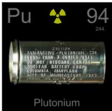
Рис. 98. Корпус плутониевой батареи для электрокардиостимулятора (плутоний -238, активность менее 3 Ки, 1973).
