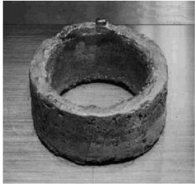
Рис. 48. Кольцо из электролитически очищенного металлического плутония (чистота более 99,96%). Такие кольца получали в Лос-Аламосе и отправляли в Роки Флетс для производства оружия. Масса кольца 5,3 кг, достаточна для изготовления современного стратегического заряда, диаметр - 11 см. Кольцевая форма важна для обеспечения критической безопасности.
