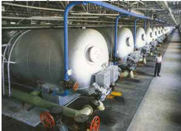
Рис. 74. Ёмкости на радиохимическом производстве где происходит процесс экстракции урана и плутония трибутилфосфатом (извлечение делящихся материалов из жидкой смеси органическим растворителем). Такая ёмкость взорвалась в 1993 на СХК.
