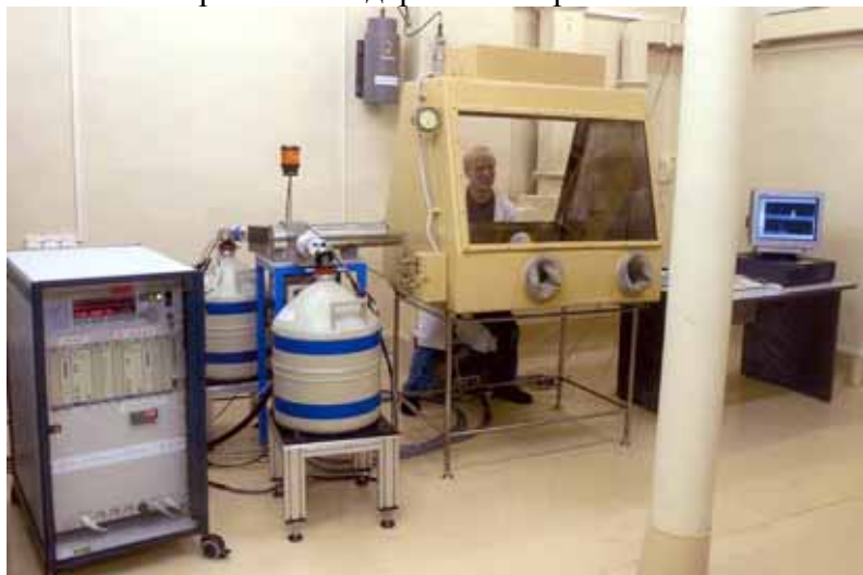
Рис. 22. Аппаратура для определения плутония и других актинидов в растворах.
