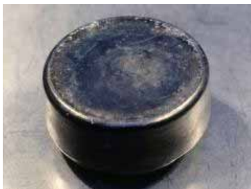
Рис. 51. Отливка из плутониево-галлиевого сплава (плутониевый пит).
