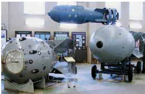
Рис. 60. Советское ядерное оружие: РДС-1 (слева), РДС-4 (вверху) – первая серийная авиационная бомба и водородная бомба РДС-6С (справа).
