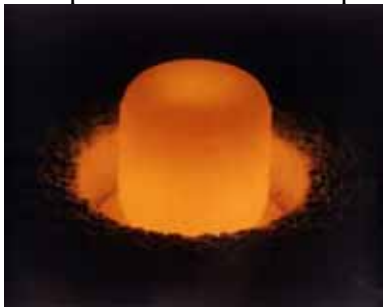
Рис. 7. Свечение блока ^{238}\text{PuO}_2 (Самонагрев).
