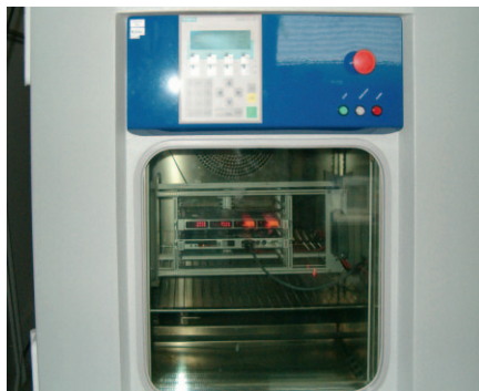
Рис. 5. Тестирование на устойчивость к воздействию климатических факторов
