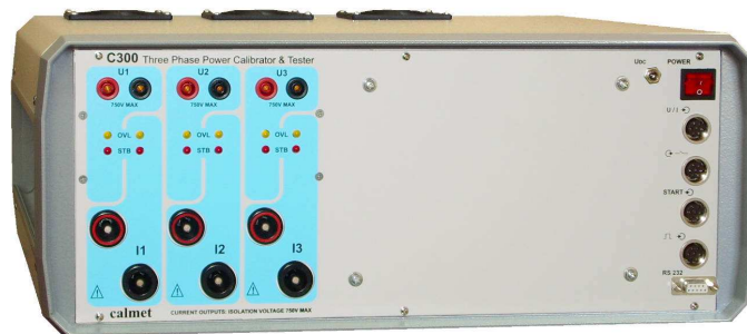
C300 trójfazowe źródło do 120A (jednofazowe do 360A) i 560V
