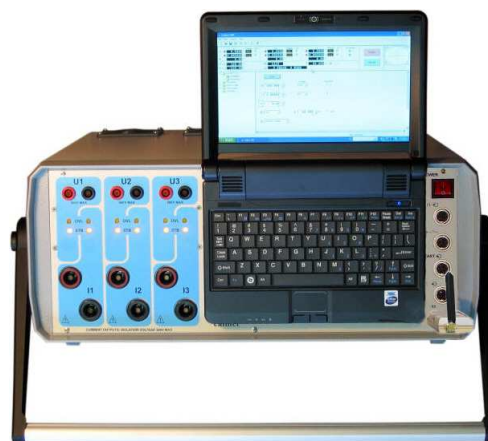
C300 z opcją sterownika Netbook 10" mocowanego za pomocą magnesów i z bezprzewodową komunikacją
