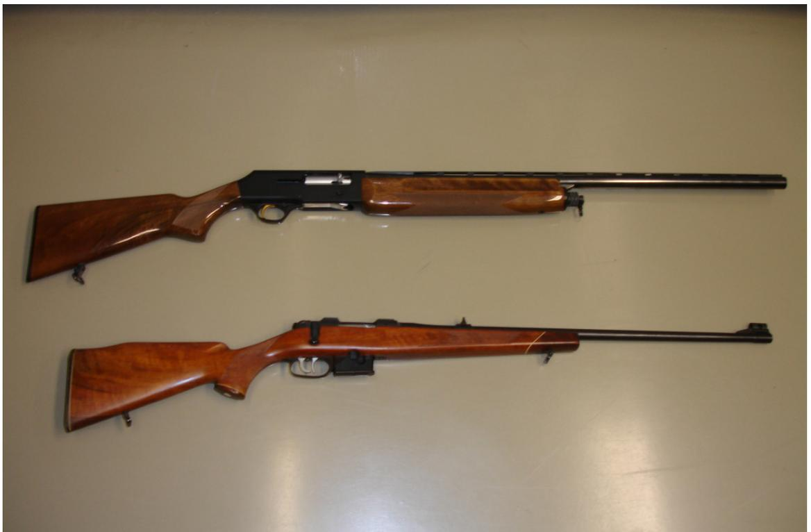
Abbildung 2: oben Büchse (gezogener Lauf) unten Flinte (glatter Lauf)
