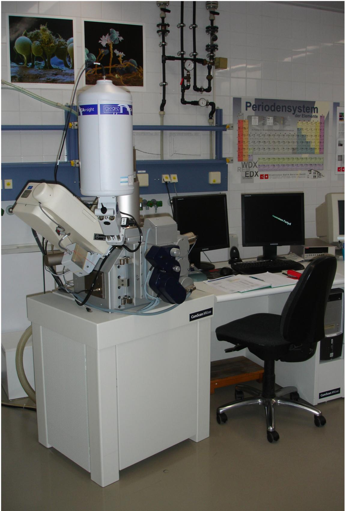
Abbildung 14: Foto eines Rasterelektronenmikroskops
