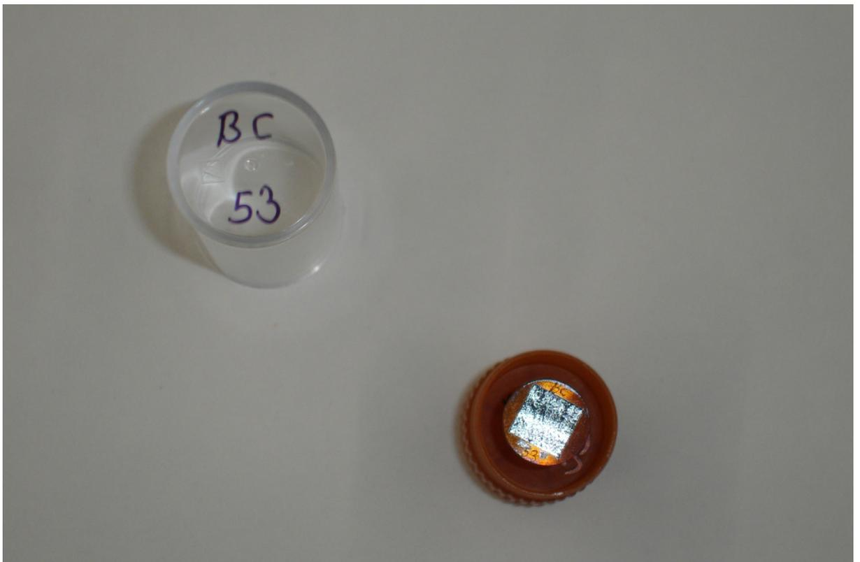
**Abbildung 16: Ansicht eines Probenellers für das REM von oben**
