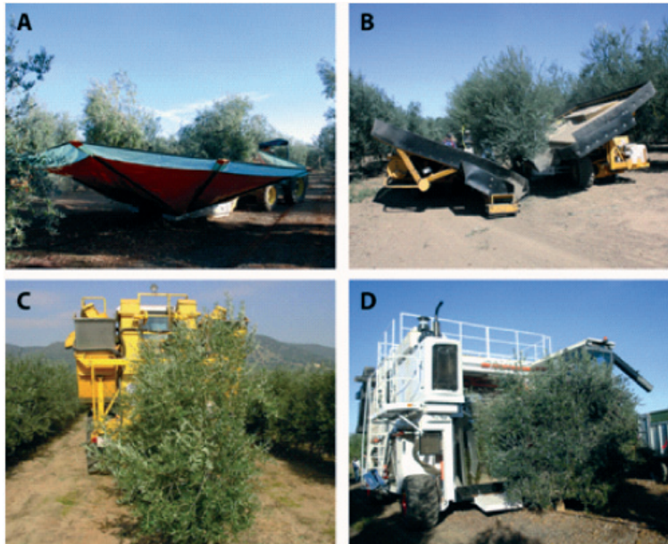
Figura 4. Cosechadoras de olivar. (A) Vibrador de tronco con paraguas invertido. (B) Vibrador de tronco autopropulsado con plataformas en tándem. (C) Cabalgadora de viñedo modificada. (D) Cabalgadora vibradora de copa
