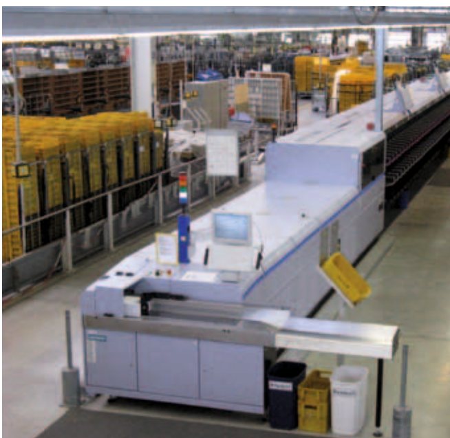
Die neue integrierte Anschriftenlese- und Videocodiermaschine in Straubing sortiert bis zu 44.000 Briefsendungen pro Stunde.
