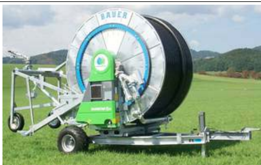
moderní počítačově řízený systém velkoplošné závlahy RAINSTAR E2 se solárním zdrojem energie
