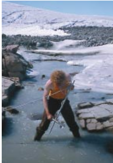
Figur 4. Måling af vandføringen i mindre smeltvandsflod fra Indlandsisen.
