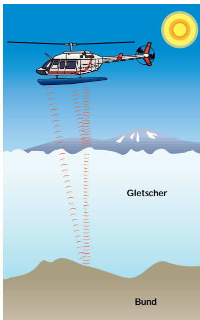
Figur 15. Princippet i radarmålinger af isens bund, se teksten for forklaring.
