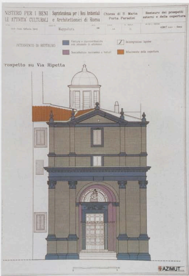
26 – SINTESI DEGLI INTERVENTI CONSERVATIVI ESEGUITI SULLE SUPERFICI DELLA FACCIATA DELLA CHIESA DI SANTA MARIA IN PORTA PARADISI
