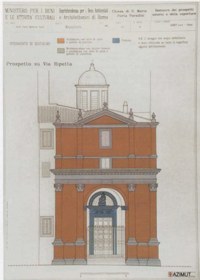
25 – SINTESI DEGLI INTERVENTI CONSERVATIVI ESEGUITI SULLE SUPERFICI DELLA FACCIATA DELLA CHIESA DI SANTA MARIA IN PORTA PARADISI (grafico dell'Azimut s.r.l., Roma)
