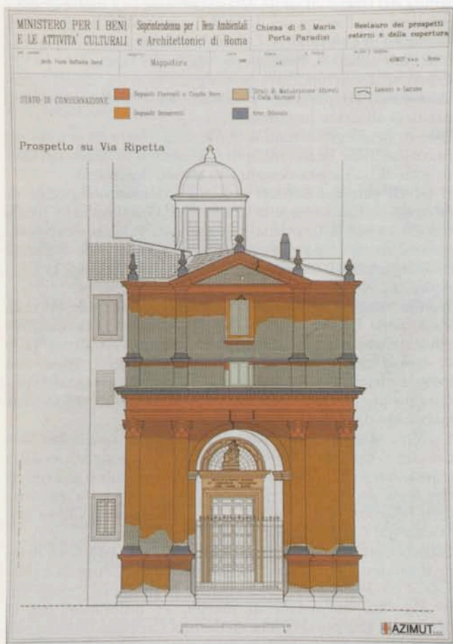
24 – RILIEVO DELLO STATO DI CONSERVAZIONE DELLE SUPERFICI DELLA FACCIATA DELLA CHIESA DI SANTA MARIA IN PORTA PARADISI (grafico dell'Azimut s.r.l., Roma)
