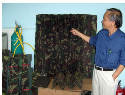
TS. Nguyễn Văn Dán bên cạnh vật liệu hấp thụ sóng ra đa dải tần S, X do ông nghiên cứu
