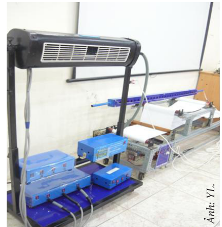
Bộ khử tĩnh điện do nhóm tác giả nghiên cứu chế tạo.
