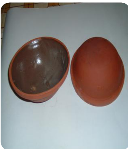
Sản phẩm thử nghiệm: chậu gốm và chén hứng mù cao su
