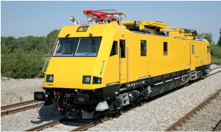
Abb. 1: Das Instandhaltungsfahrzeug für Oberleitungsanlagen ROBEL 57.44
