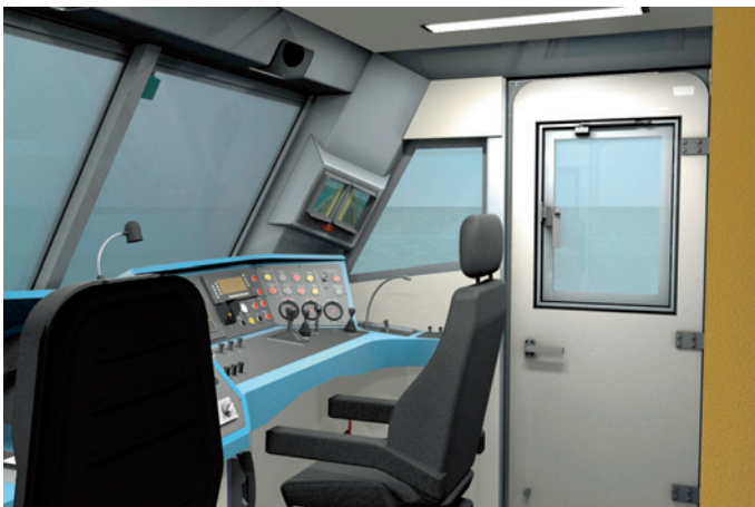
Abb. 2: Innenansicht eines Führerraumes; über dem Pult gut erkennbar: die Monitore der Rückfahrkameras
