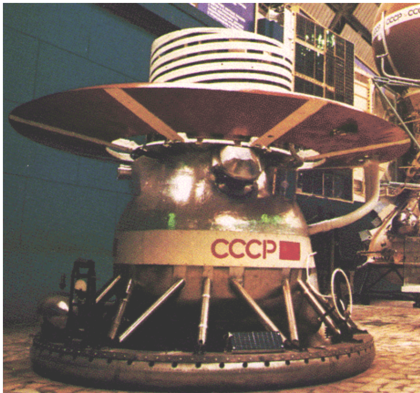
Рис.1. Аппарат ВЕНЕРА-13 на сборке и испытаниях в НПО им. Лавочкина.
