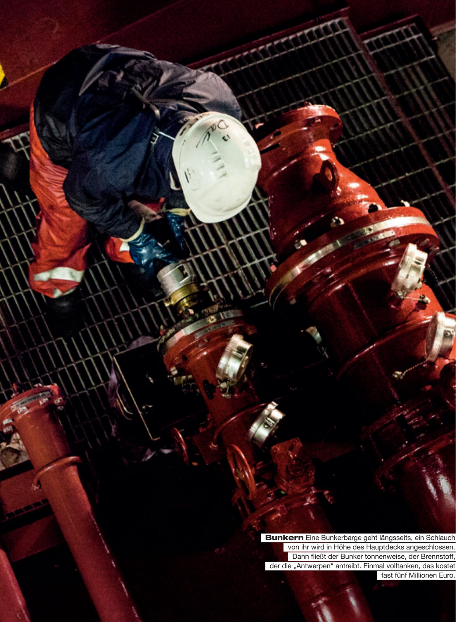
**Bunkern** Eine Bunkerbarge geht längsseits, ein Schlauch von ihr wird in Höhe des Hauptdecks angeschlossen. Dann fließt der Bunker tonnenweise, der Brennstoff, der die „Antwerpen“ antreibt. Einmal volltanken, das kostet fast fünf Millionen Euro.
