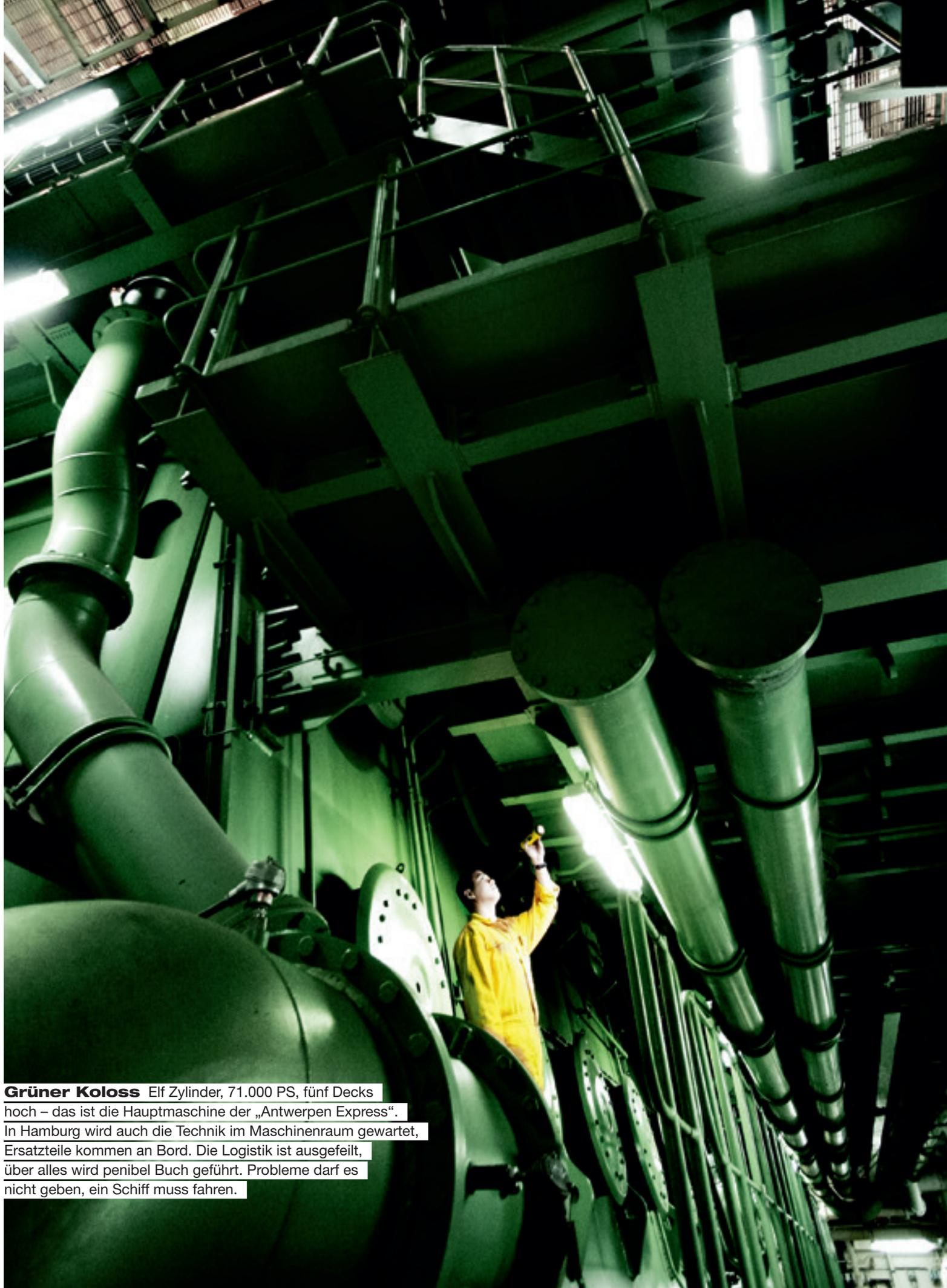
**Grüner Koloss** Elf Zylinder, 71.000 PS, fünf Decks hoch – das ist die Hauptmaschine der „Antwerpen Express“. In Hamburg wird auch die Technik im Maschinenraum gewartet, Ersatzteile kommen an Bord. Die Logistik ist ausgefeilt, über alles wird penibel Buch geführt. Probleme darf es nicht geben, ein Schiff muss fahren.
