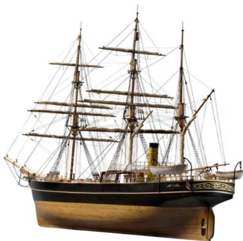
A.E. Nordenskiöld var den första som med fartyget Vega tog sig fram genom nordostpassagen. Skeppet Vega var ursprungligen en valfångare, byggt 1873. Hon var ett relativt litet fartyg, mätte 357 registerton och hade en total längd om 43,4 meter. Här en modell av Vega .
