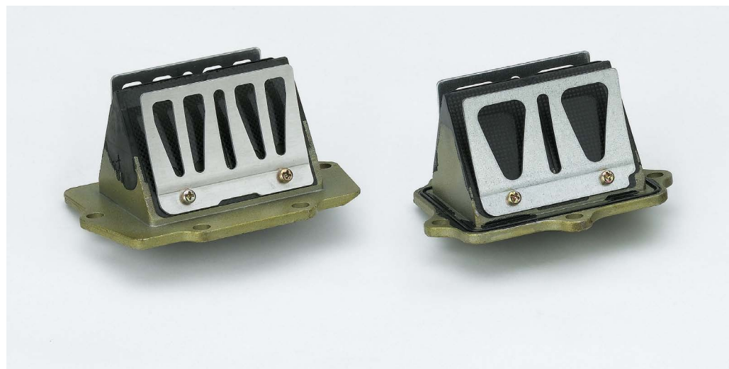
Nei motori a due tempi di serie l'ammissione della miscela aria-carburante nella camera di manovella (solo aria se l'alimentazione è a iniezione diretta) è controllata da valvole a lamelle
