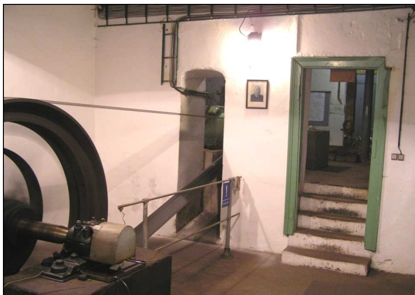
Velký setrvačnick s řemenem na hřídeli poháněný turbinou.
