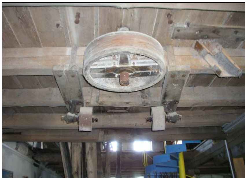
Hřidel s řemenicí na mlecí kameny.
