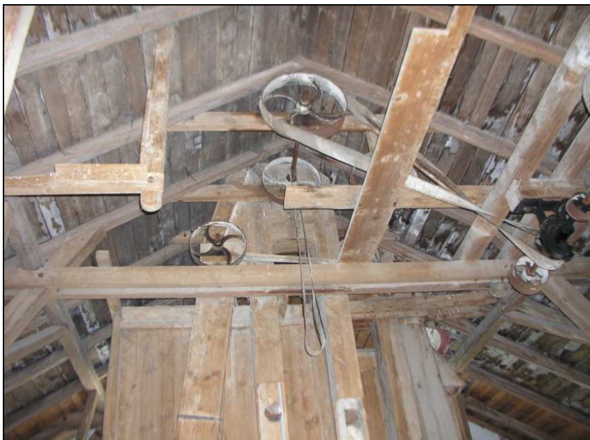
Překřížením řemenu se docílilo opačného směru otáček.
