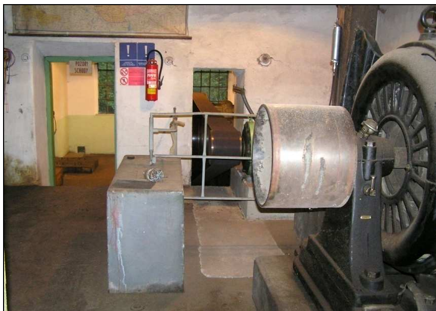
Generátor na výrobu elektrické energie, vzadu otvor pro pohon řemenem.
