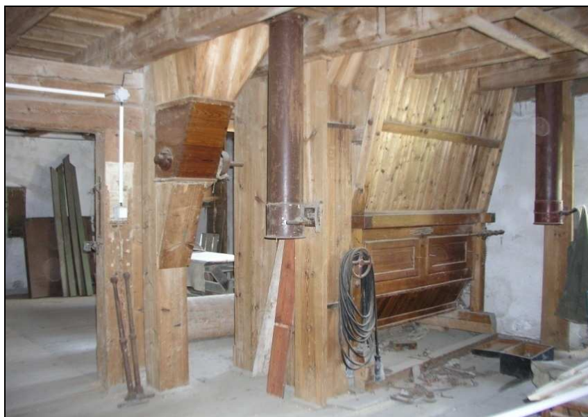
Dopravní zařízení pro melivo a produkty.
