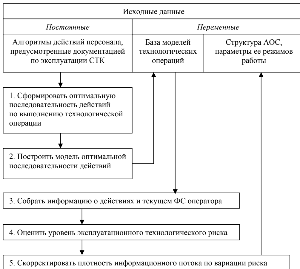
Рис. 2. Структурная схема методики адаптации АОС к индивидуальным особенностям операторов
