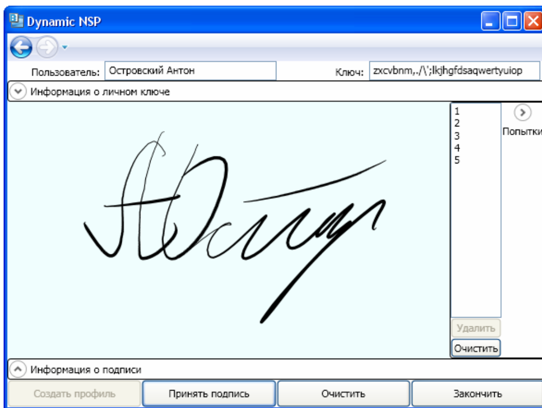
Внешний вид программы динамической биометрии подписи (данный рисунок отображает актуальность учета степени нажатия пера – чем больше давление, тем толще линия)
