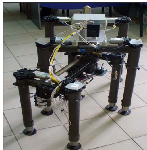
Рис. 1. Мобильный робот с ортогонально-поворотным движителем:
