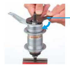
TL-7520 Tightening torque: 12-20 Nm (120-200 kgfcm)
