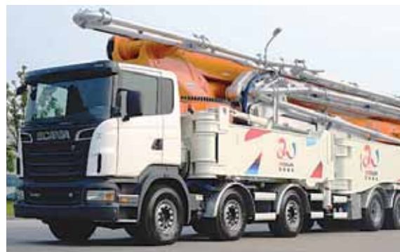
Автобетононасос KCP 47 M-5
