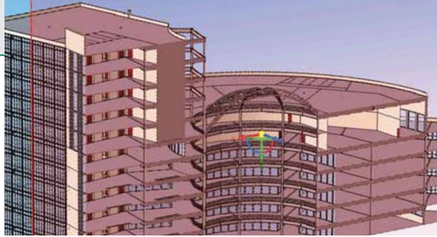
Рис. 7. Функція «Перетин моделі» дозволяє проконтролювати 3D-модель і поглянути на споруду під будь-яким кутом
