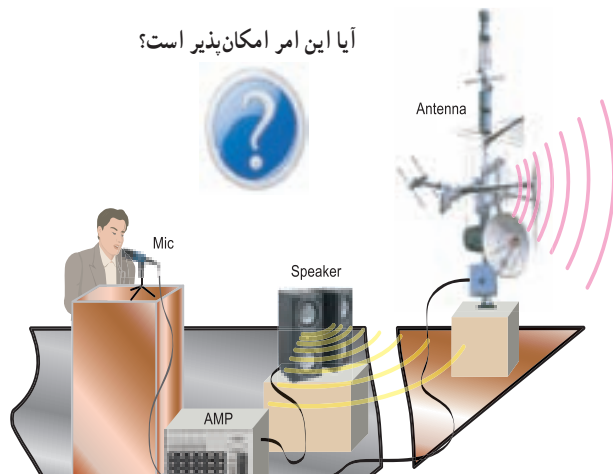
شکل ۳-۷- تبدیل امواج صوتی به امواج الکترومغناطیسی
