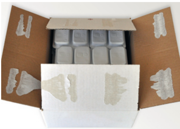
Jowat-Toptherm® 256.85 – Verhalten beim Ausrisstest
