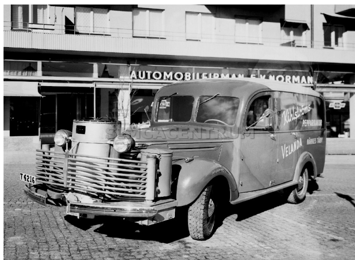
Poválečná palivová nouze zasáhla i Skandinávii a dřevoplynovým pohonem byla vybavována i zcela nová auta
