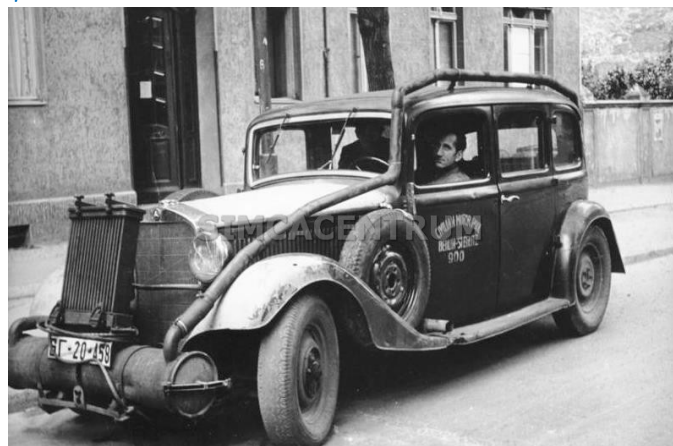
Poválečná palivová nouze zasáhla i Skandinávii a dřevoplynovým pohonem byla vybavována i zcela nová auta
