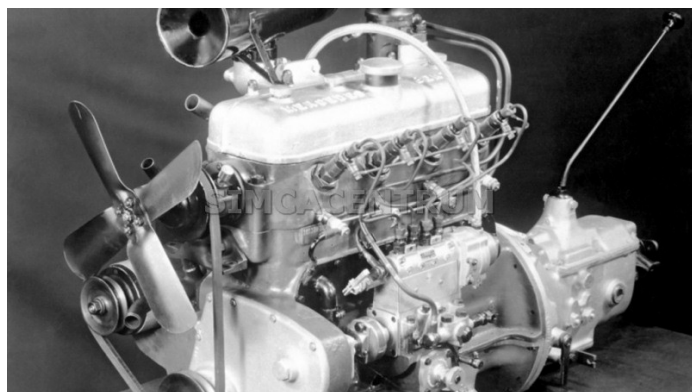
Za první seriové auto se vznětovým motorem je pokládán Mercedes-Benz 260 D z roku 1936. Na vedlejším snímku detail motoru.
