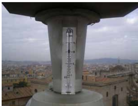
Foto 6 Il flussimetro montato sulla fenditura di aspirazione del campionatore (a) e particolare (b).
