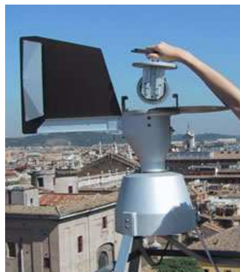
Foto 9 Il cambio del nastro di campionamento.
