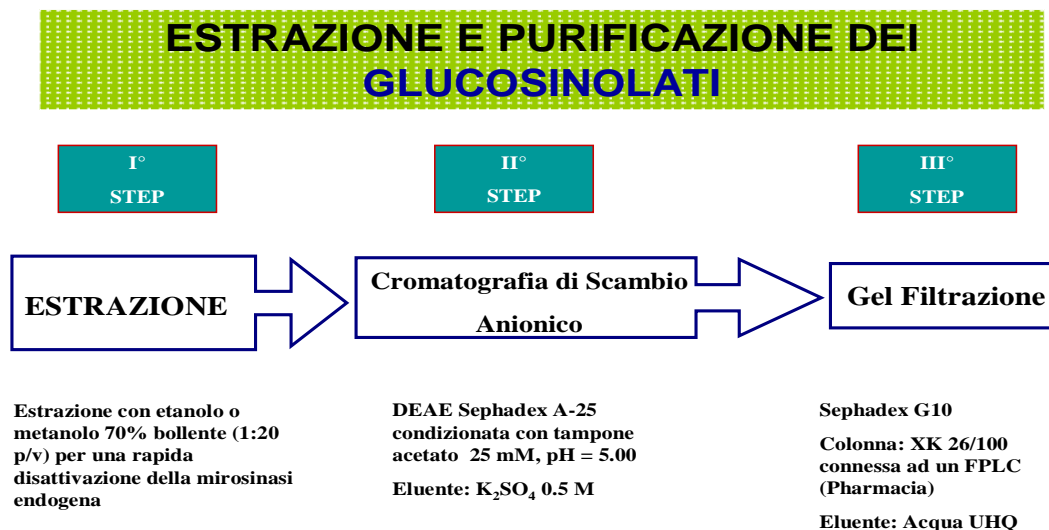
Figura 7 – Metodo per la purificazione dei glucosinolati
