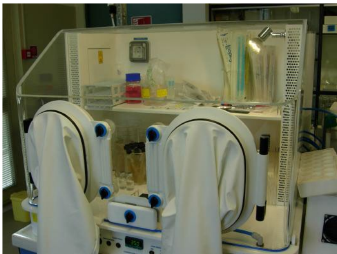
Foto 1 Una camera anaerobica per la coltivazione dei microorganismi in assenza di ossigeno.
