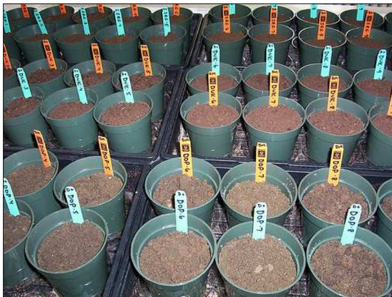
Figura 4 - I campioni di suolo posti ad essiccare in vasi di plastica al buio e in luogo areato.
