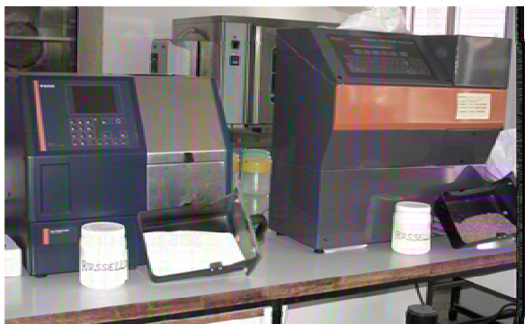
Foto 4 Determinazione del contenuto proteico e del glutine, su semola e granella, mediante strumentazione NIT (Near Infrared Trasmittance).
