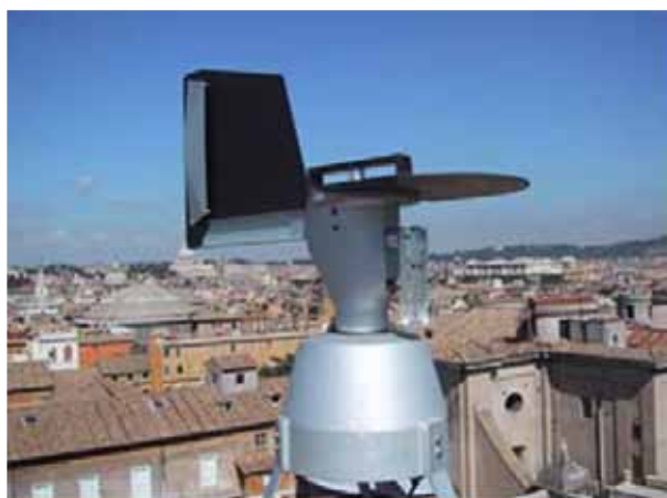
Foto 6 Il flussimetro montato sulla fenditura di aspirazione del campionatore (a) e particolare (b).
