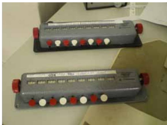
Foto 17 Conta-cellule manuali impiegati per la conta dei pollini e delle spore.
