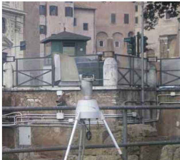
Foto 5 Il campionatore installato nell'area archeologica di Sant'Omobono, visto da lontano (a) e da vicino (b).
