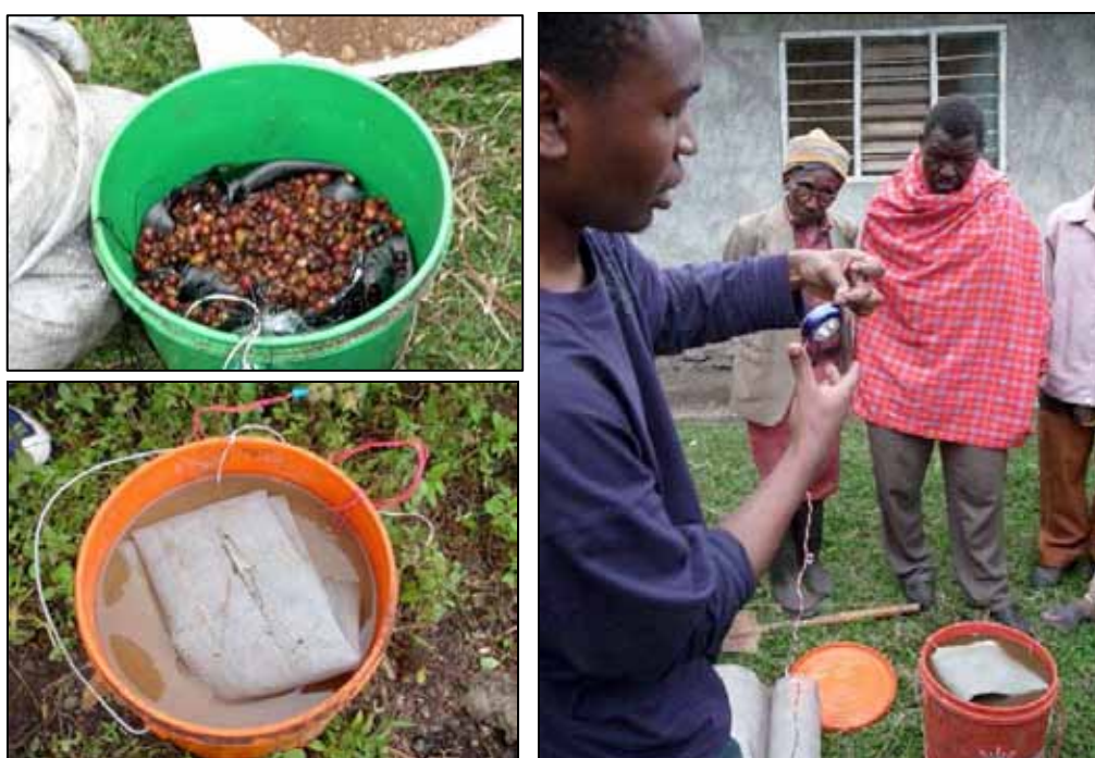
Figura 10 – Utilizzo della tecnologia MFC per accendere una lampadina utilizzando l'energia elettrica prodotta da batteri elettrogenici a partire da biomasse di scarto ( www.lebone.org ).
