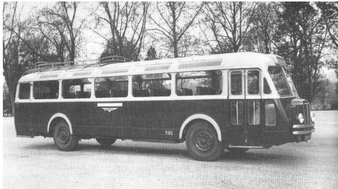
*A gauche, girouette de direction et porte avant dans le porte-à-faux pour cet AP 2 version APE ou APH, sans nez de cochon réservé alors à l'AH. La ventilation peut être améliorée par le coulisement vers le bas, commandé par une manivelle, de la partie inférieure des pare-brises.*
