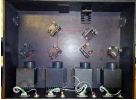
Рисунок 9. Передатчик ОЛС. Прохождение лучей
