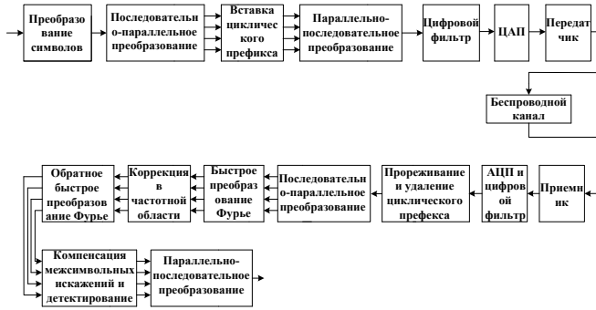
Рис. 6 – Схема мультиплексирования одной несущей с коррекцией в частотной области (SC-FDE) [6]
