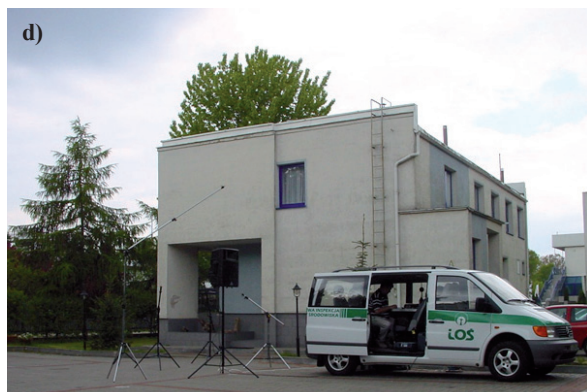
Rys. 6. Międzylaboratoryjne badania hałasu – aktywności na poligonach pomiarowych (przykłady): a – ruchome laboratorium akustyczne obsługujące źródła sygnałów akustycznych, b – przygotowania do badań mocy akustycznej urządzenia, c – przygotowanie aparatury do badań porównawczych (przy ruchomym laboratorium pracownicy Zakładu Akustyki), d – tor emisji wzorcowych sygnałów akustycznych podczas badań porównawczych
