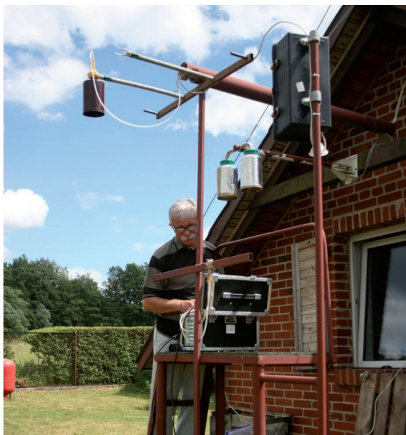
Fot. 3. Stanowisko pobierania próbek zanieczyszczeń powietrza (Foto: Archiwum T. Śnieżek)
