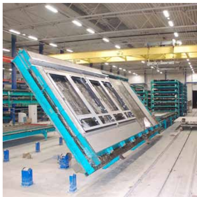
Aus einem Guss: Produktion von Rippendecken (links) und Außenwandelementen inklusive Fenstern und Sonnenschutz im GOLDBECK Werk Hamm.
