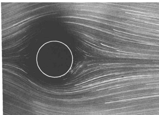
Рисунок 5.3 Обтекание цилиндра. Безотрывный режим. Re=1.54
