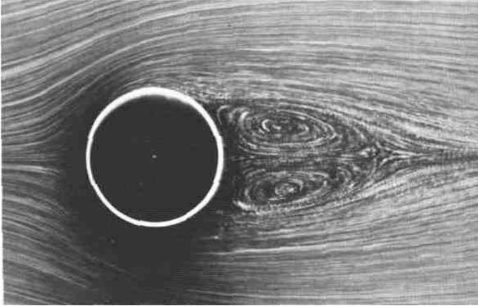
Рисунок 5.5 Отрывное обтекание цилиндра, Re=26
