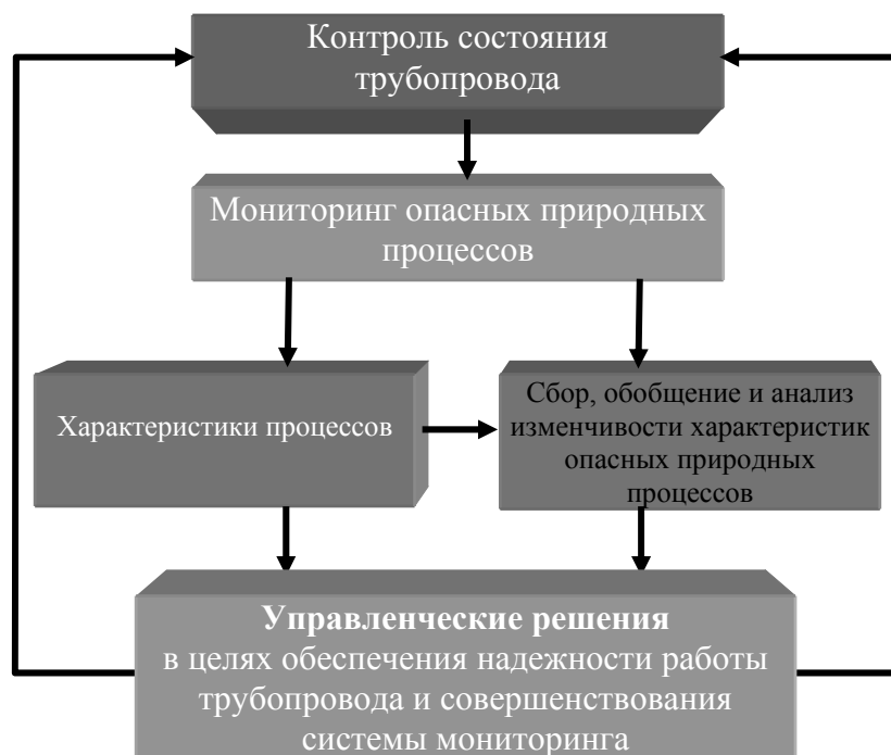
Рис. 9. Схема организации мониторинга опасных природных процессов на участках перехода трубопроводов через реки [Сергеев, 2006]
