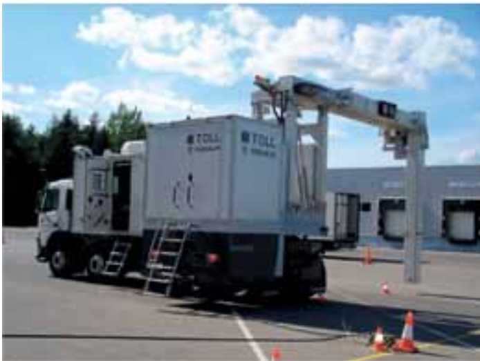
Eesti tollipunktides on tehnika ja oskused selleks, et kaubandust tõhusalt kontrollida. Pildil liikuv röntgeniaparaat. Foto: maksu- ja tolliamet
