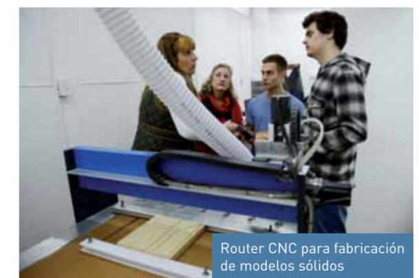
Router CNC para fabricación de modelos sólidos
