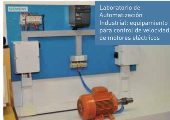
Laboratorio de Automatización Industrial: equipamiento para control de velocidad de motores eléctricos
