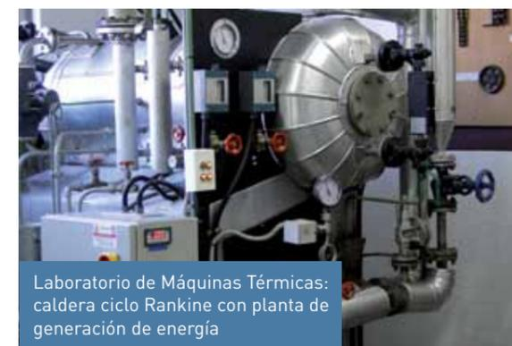
Laboratorio de Máquinas Térmicas: caldera ciclo Rankine con planta de generación de energía
