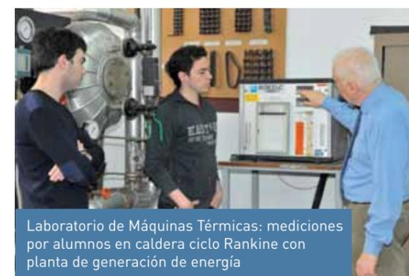
Laboratorio de Máquinas Térmicas: mediciones por alumnos en caldera ciclo Rankine con planta de generación de energía
