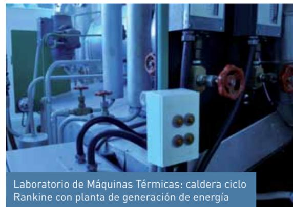
Laboratorio de Máquinas Térmicas: caldera ciclo Rankine con planta de generación de energía
