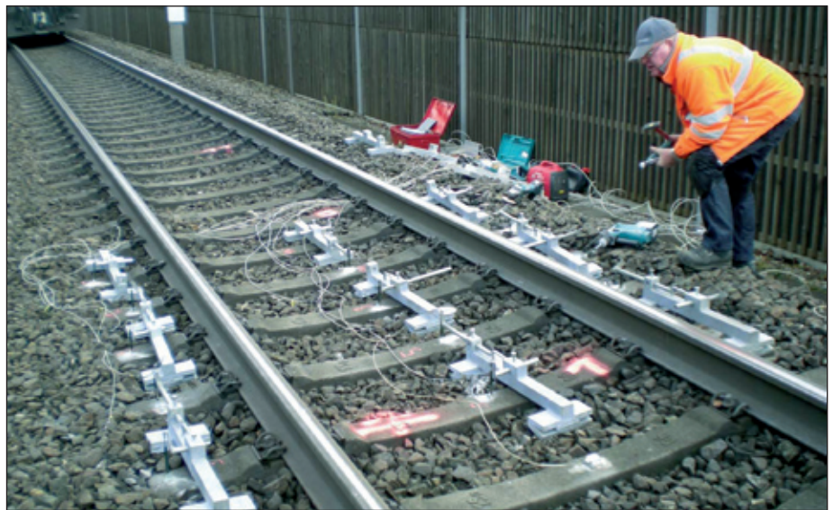
Abb. 9: Messaufbau zur Bestimmung der relativen vertikalen Schwelleneinsenkungen (Hersteller Messequipment PJM)
