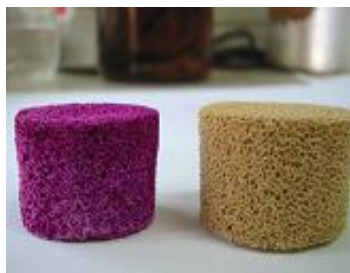
Figura 5. Fotos de los filtros. Izquierda: filtro final después de 3h de contacto. Derecha: filtro inicial antes del contacto con el efluente M4.
