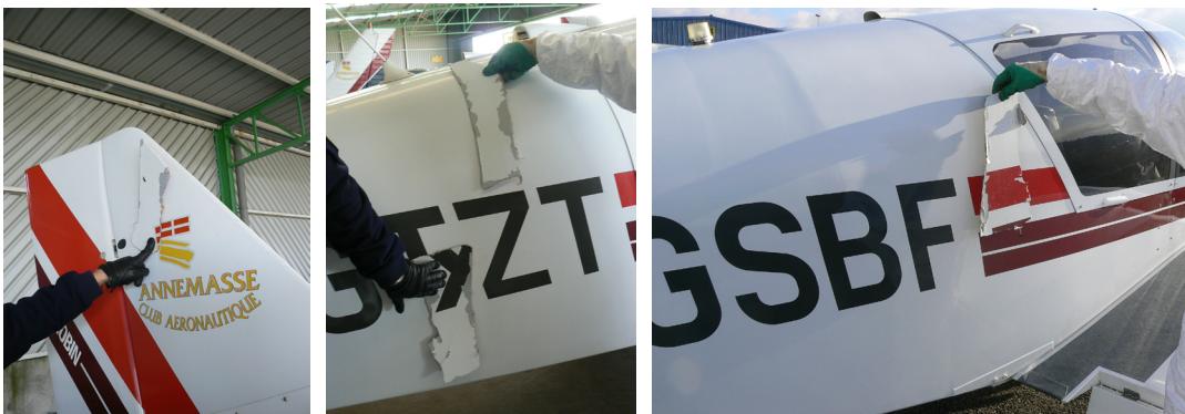
Débris de fuselage du DR 400 présentés sur d'autres avions du club, de même type
