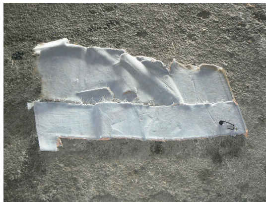
Débris de moquette présentant des coupes droites causées par l'hélice du PA 28
