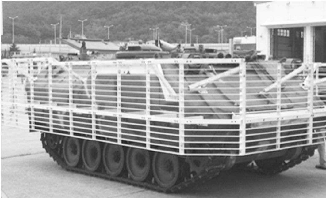
그림 5. K200A1 장갑차에 장착된 SLAT 장갑
