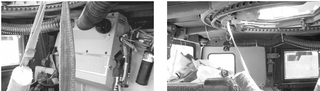
그림 10. 험비 내부에 설치된 에어컨(좌) 및 송풍호스(우) 7)
