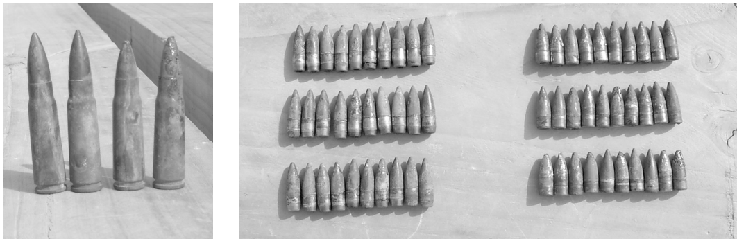
그림 6. Mild core탄과 보통탄(좌) 및 Mild core탄두와 보통탄두(우) 4)
