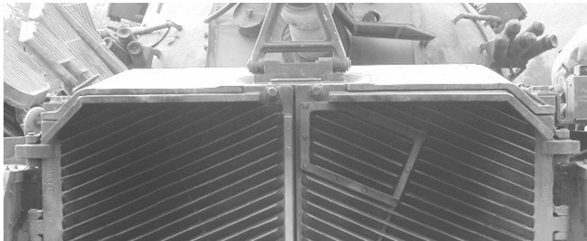
그림 20. M계열 전차 후방엔진 덮개(방열을 용이하게 하기 위해 공간 존재)
