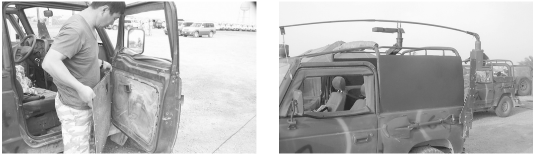
그림 15. 운전병/선탐자 방탄작업(좌)과 차량 측면에 5mm 철판장착(우)
