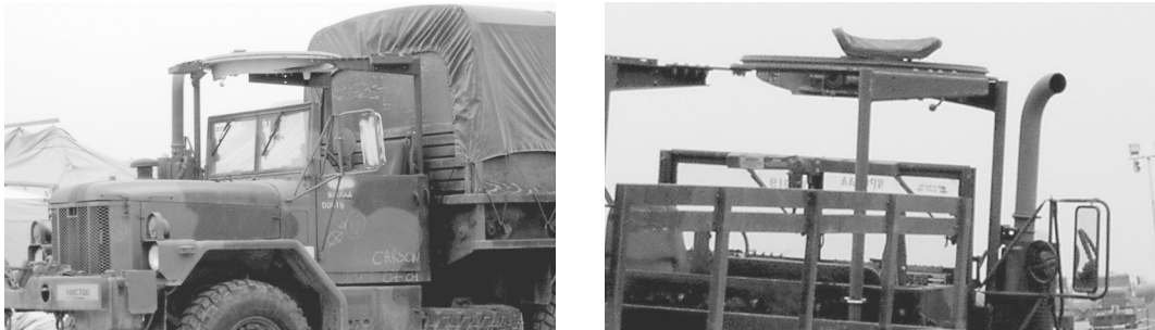
그림 11. 2½톤 및 5톤 선탑좌석 상판에 전방향 사격가능토록 설치된 거치대 8)
