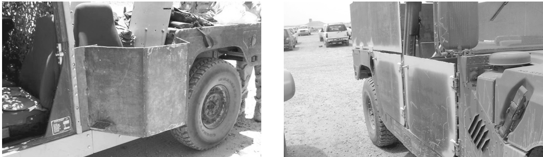
그림 13. 사격범위 확대를 위한 발판확장 및 측면보호판(좌), 철판으로 보강된 문과 적재함(우) 9)
