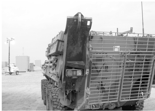
그림 3. LAV에 장착된 봉상형 장갑(SLAT장갑 원리와 동일) 2)
