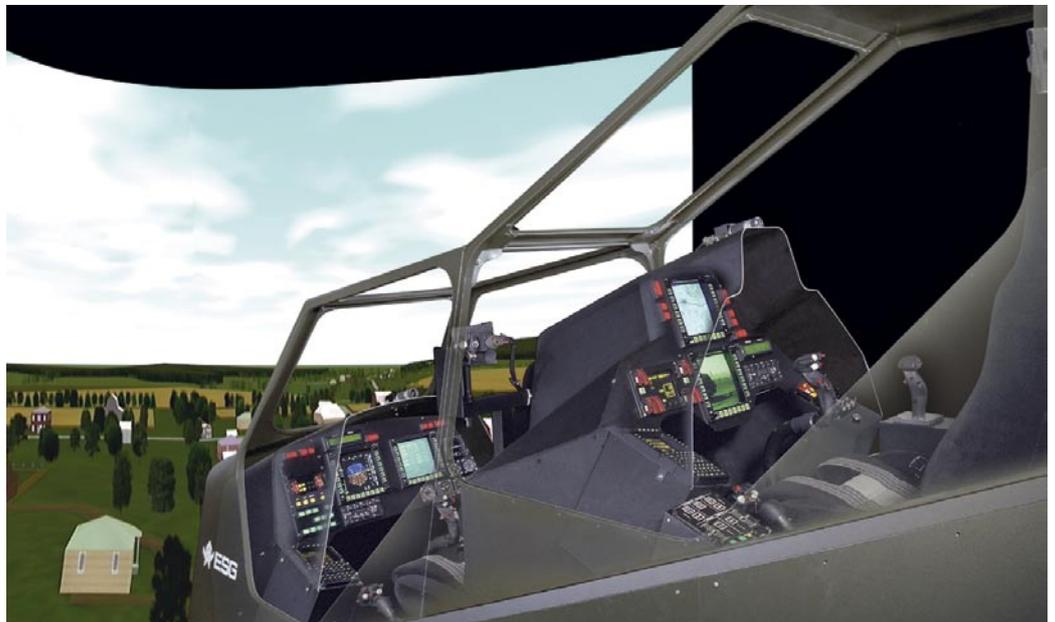
Seit 1990 ist die ESG an der Entwicklung des Hubschraubers TIGER beteiligt. Im Cockpit-Versuchsaufbau (CVA), einem Flugsimulator, können Entwicklungen frühzeitig getestet werden.
