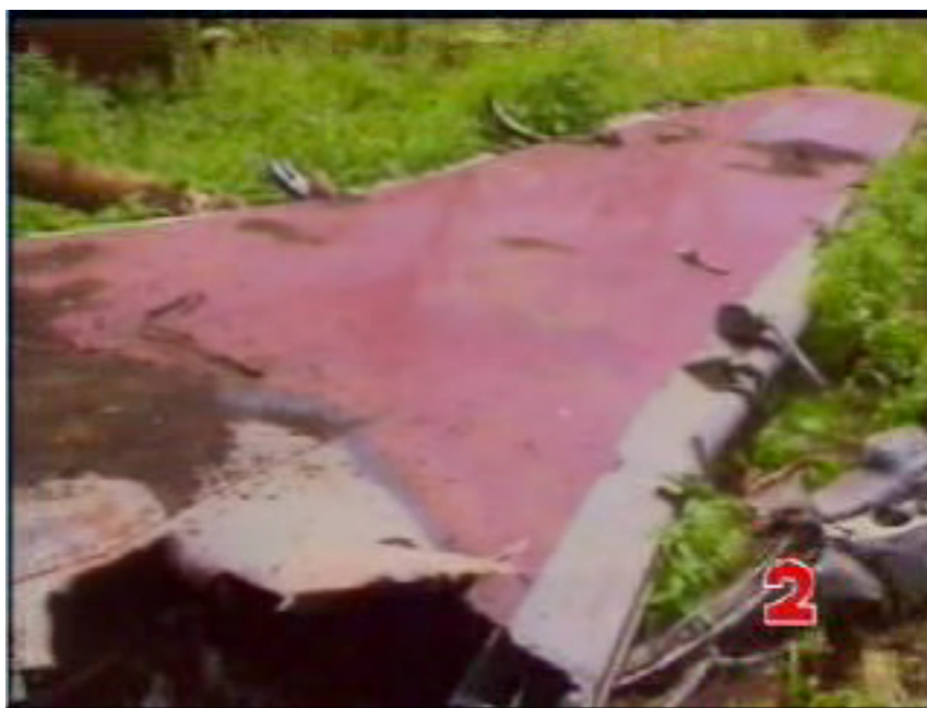
FIGURE 7.10 – Même aile avec trou sur le bord avant et trace de feu. Source : France 2, 28 juin 1994, journal de 13 heures. Archives INA
