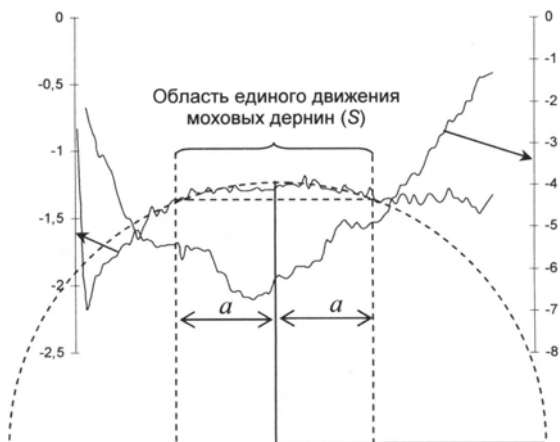
Рис. 6. Разномасштабный профиль Локотенского болота (справа представлен масштаб поверхности болота в метрах (м), слева – минерального дна болота (м); сфера показывает морфологическую целостность области единого движения мхов)
