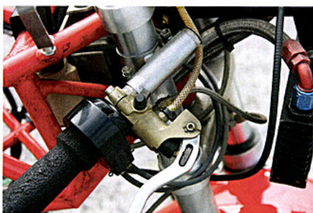
• In alto, sul semimanubrio sinistro Tommaselli si notano la pompa del comando idraulico della frizione e il bottone di massa. Qui sopra invece, la pompa freno Brembo Serie Oro.
