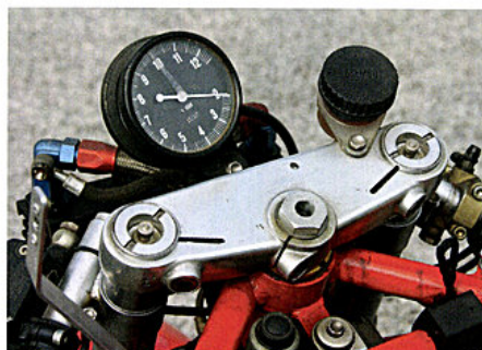
• Sopra, il contagiri Veglia con zona rossa a 10.000 giri. Il motore 750 F1 - estrema evoluzione della serie Pantah - ha 90 CV a 10.000 giri. Il bicilindrico sperimentale 4 valvole che ha corso al Bol d'Or 1986 (con ancora un basamento Pantah) si spingeva già a 11.500 giri. Stesso valore per la prima 851 (che aveva circa 115 CV), ma a Lucchinelli era stato consigliato di non superare la soglia degli 11.000 giri, se non in casi di estrema necessità.
